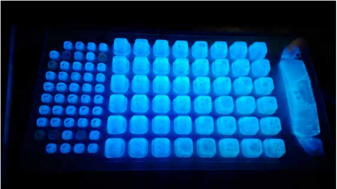
Enterolert® Quanti-Tray/2000 -luentaliuska, jossa positiivisiksi enterokokeiksi tulkittavat kaivot fluoresoivat sinisenä.
