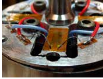
Mittakalvon murtuminen ulomman nivelkohdalta. Huomaa myös venymäliuskojen sijainti ja rakenteen monimutkaisuus.
