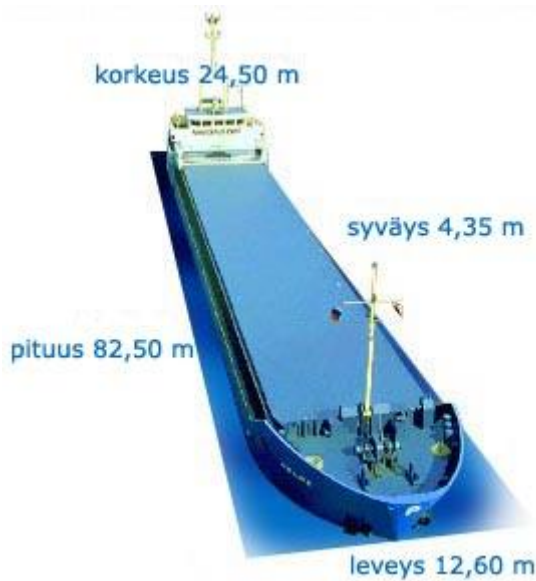
Kuva 2. Saimaan kanavassa liikennöivän aluksen maksimimitat (Merenkulkulaitos c.)
