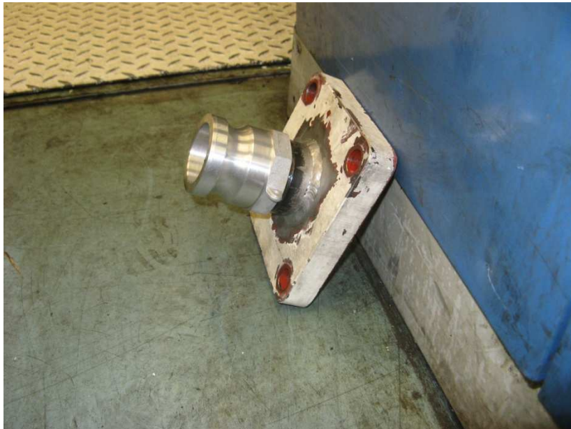
Kuva 13. Koeajossa valmistettu liitinkappale öljyputken liittämiseksi moottoriin.
