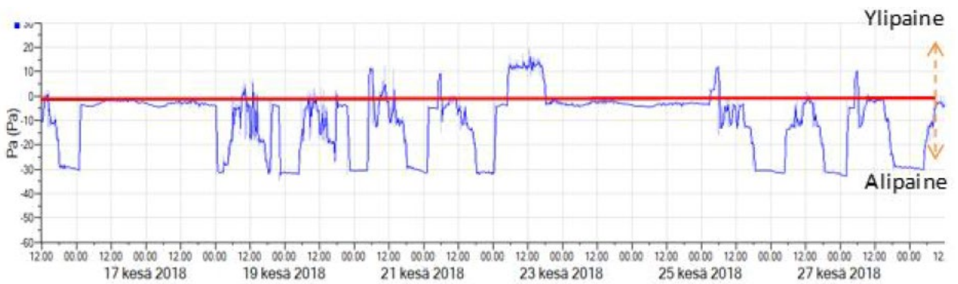
Kuvaaja 2. Ilmanvaihdon aiheuttamat paine-eron vaihtelut (Vahanen Rakennusfysiikka Oy 2018)
