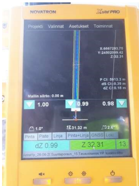
KUVA 2. Kuva Novatronin 3D-koneohjausjärjestelmän näytöstä.
