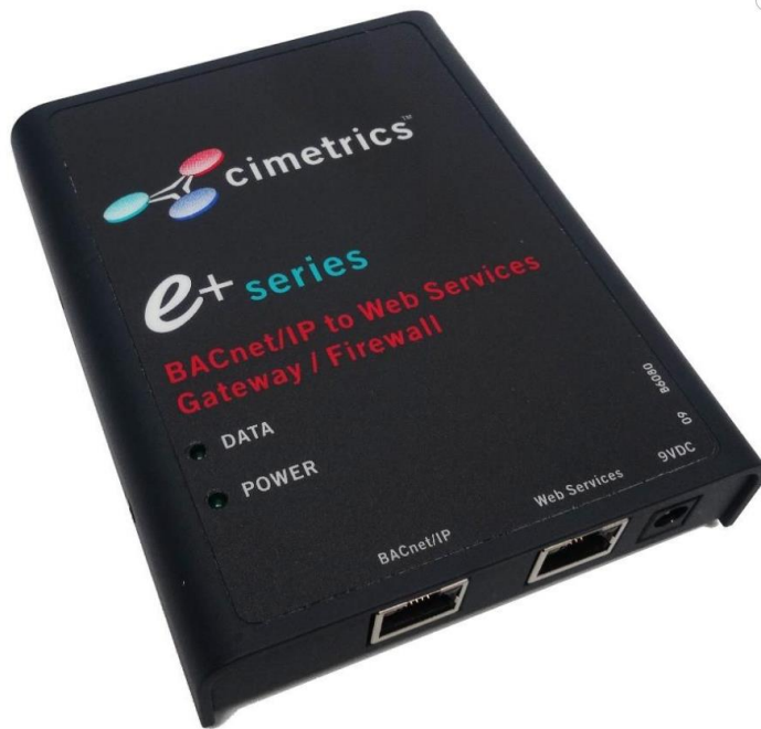
Kuvio 12. Rajapinnassa käytetty Cimetrics B6080 laite
