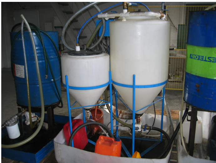
KUVIO 17. Käytössä oleva osittain omavalmisteinen Fuelmeister 150LE esteröintilaitteisto
