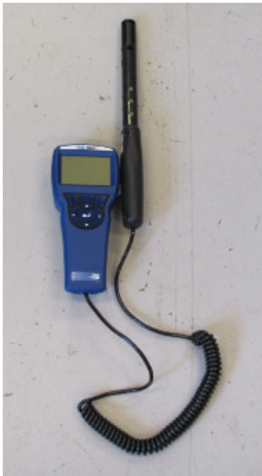
KUVA 4. Ilman laadun mittauksissa käytetty CO 2 -mittari TSI IAQ-CALC 7535.
