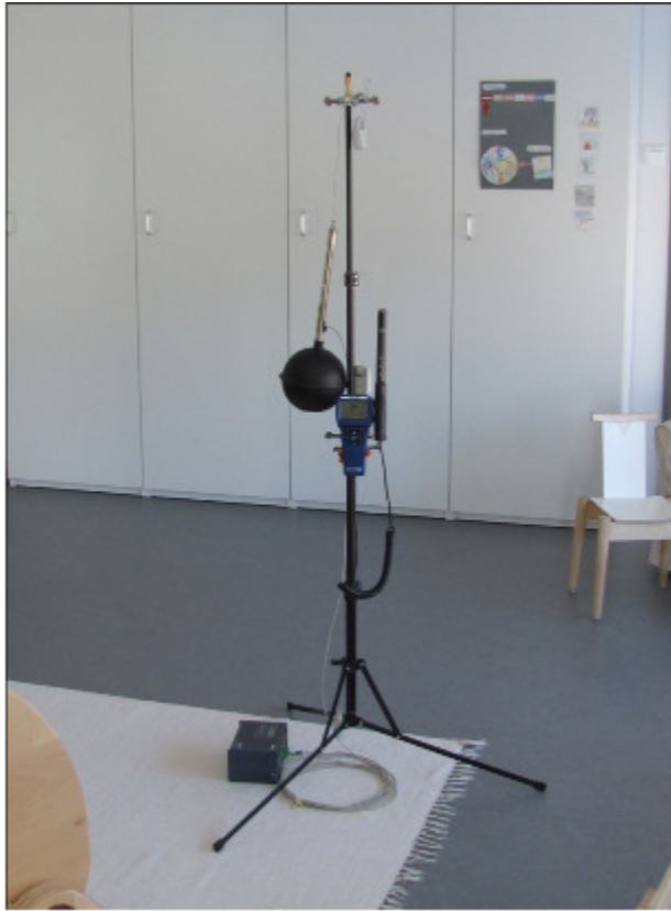
KUVA 1. Lämpöolosuhteiden ja ilman laadun mittausjärjestelmä.
