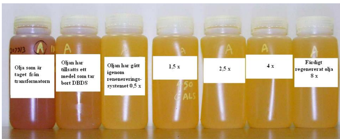
Figur 15. Färgförändring av olja under regenerering
