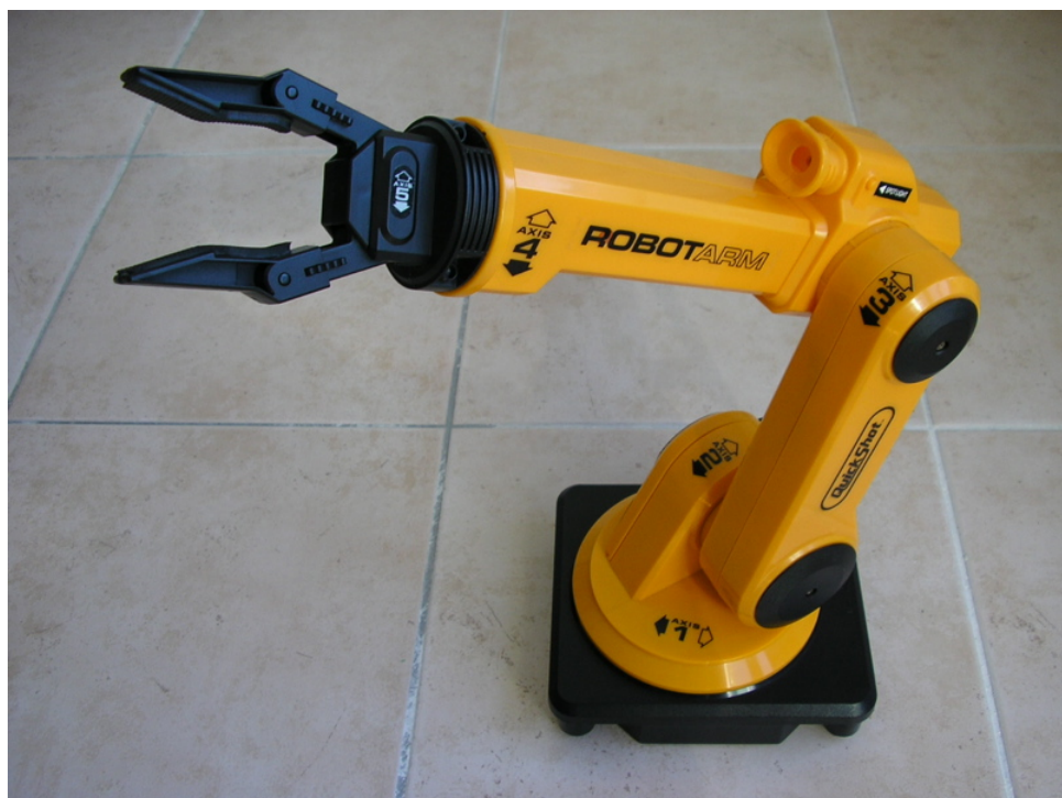
KUVIO 32. Viidennen vapausasteen robottikäsi (manipulaattori)
