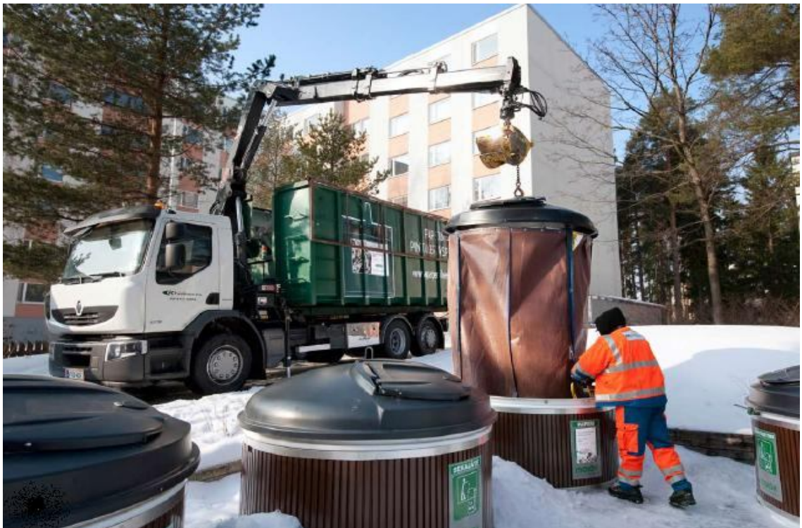
Kuva 5 Syväkeräysastian eli Molok-säiliön tyhjennys
