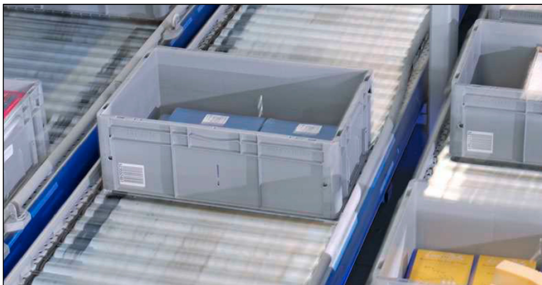
Kuva 6. Varastoautomaatissa käytettävä viivakooditunnisteellinen muovilaatikko rullakuljettimella (SSI Schäfer 2019, A26).
