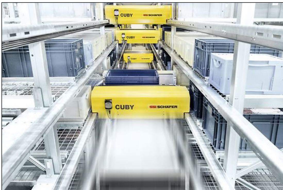
Kuva 5. Muovilaatikoita käsittelevän varastoautomaatin sukkuloita (SSI Schäfer n.d.).
