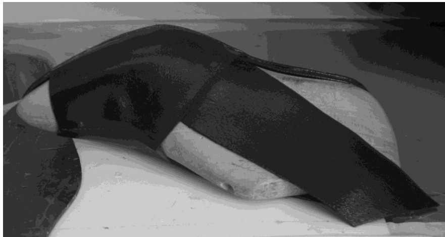
Kuva 27 Lestin päälle pinnattu runko palojen kiinnitystä varten.
