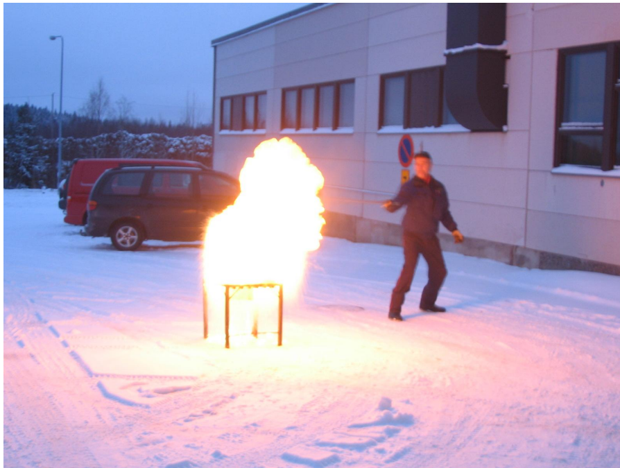
KUVA 12. Vain 0,5 desilitraa vettä puolen litran rasvapaloon sai aikaan monta metriä korkean tulipatsaan. (Taivassalo 2008)
