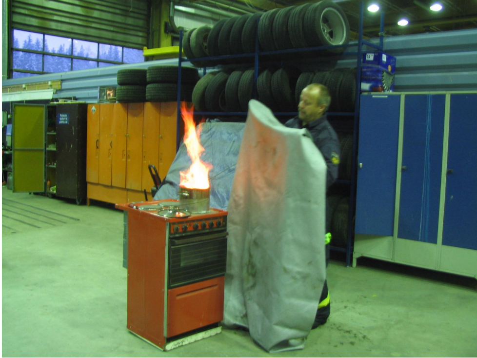
KUVA 15. Sammutuspeite ei kulu vuosienkaan käytössä. Mallia rasvapalon sammuttamiseen näyttää palomies Pauli Jääskeläinen. (Taivassalo 2008)
