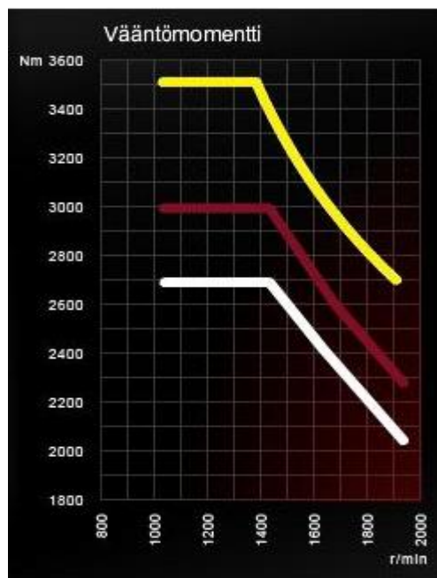
Kuva 5. Scanian moottoreiden R560 (valkoinen), R620 (punainen) ja R730 (keltainen) vääntöerot (Scania 2010).
