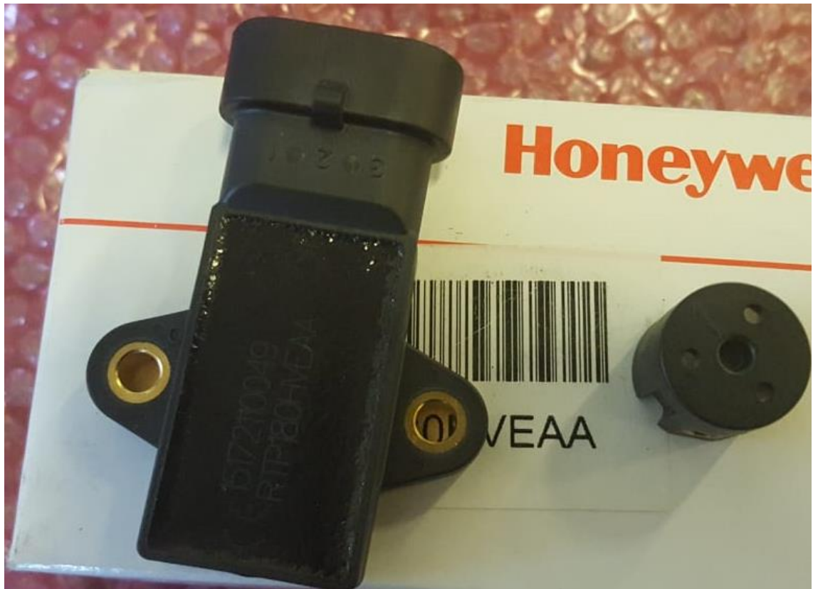
Kuva 1. Trukkihaarukkaan asennettava magneettianturi.
