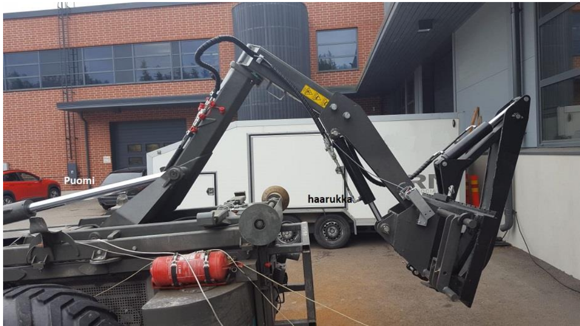
Kuva 5. Trukkihaarukka ja puomin geometria.
