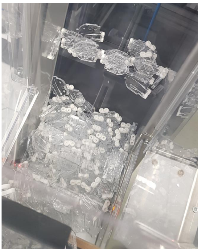
Kuva 23. Kuilu kansille, jossa näkyy punainen anturin valonsäde vasemmalla ja vastaanotin oikealla oranssina.
