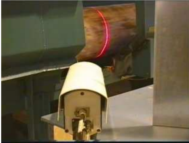
Kuva 4. ProfiScan-1 järjestelmä. Tukinpyöryksen ohjausta seuraa kamera.
