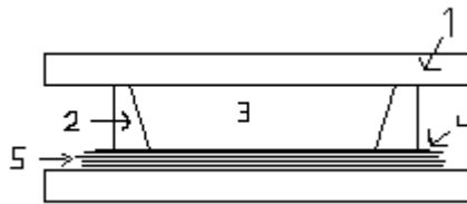
Kuva 1. Vedenpidätyskyvyn mittaaminen 1. Pleksilevy, 2. Muotti, 3. Laasti, 4. Harsokangas, 5. Suodatinpaperit
