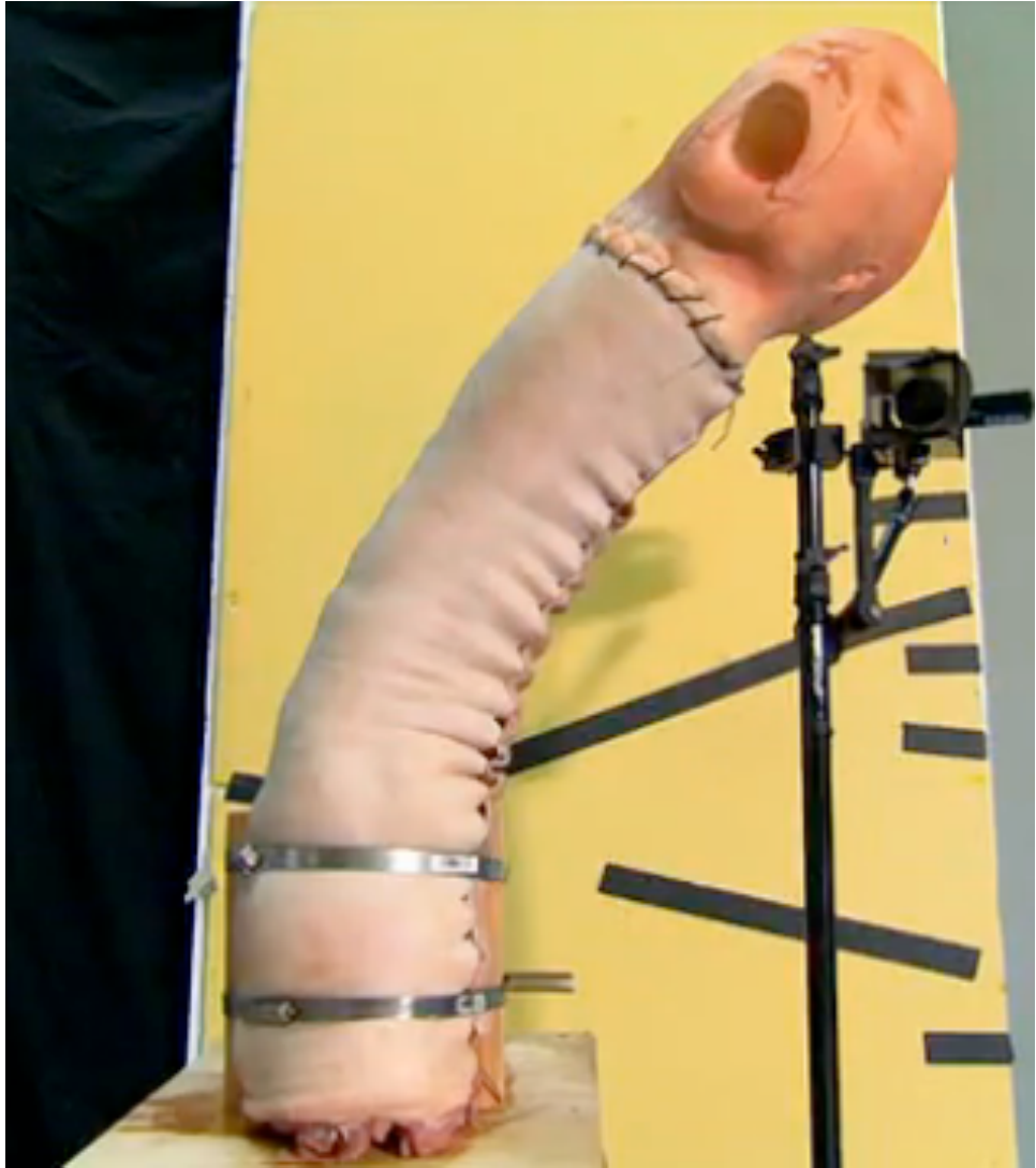
sian selkäranka, lihaa ja nahkaa ommeltu putkeksi simuloimaan ihmisen kaulaa, kun testataan voiko ikkunalasi katkaista ihmisen kaulan jos lasi lentää hurrikaanissa suurella nopeudella. Putken päähän on liitetty kumipää.
