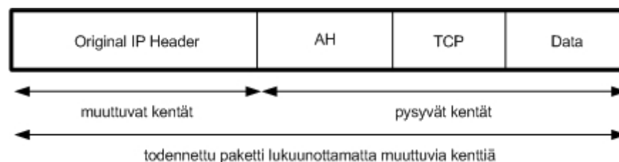
KUVIO 11. IPv4-paketti, AH lisättynä, Transport-tilassa
