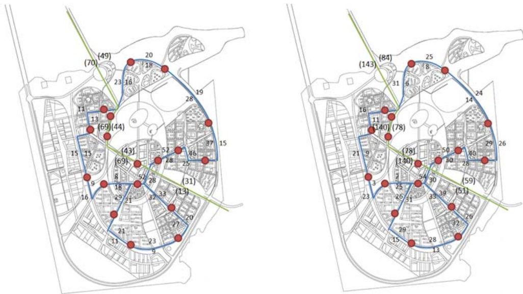
Kuva 18. Vaihtoehtojen 1-1-1 (vasen kuva) ja 3-1-2 (oikea kuva) bussien keskimääräiset matkustajamäärät linjojen eri osissa. Suluissa olevat numerot kuvaavat vihreän linjan matkustajamääriä.
