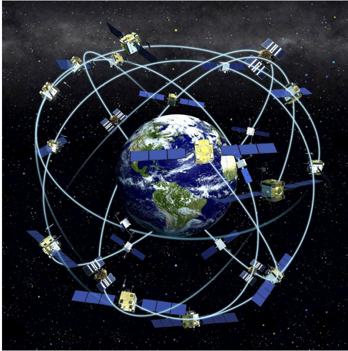
KUVA 3. GPS- konstellation sisältämät kuusi ratatasoa /10/
