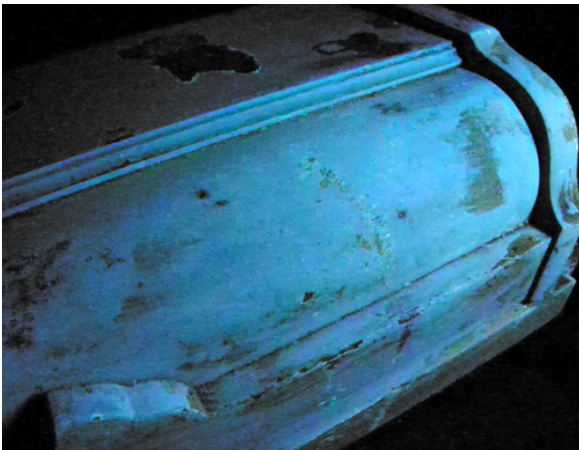
Kuva 8. Seinäpuhelin UV-valon alla. Pinta fluoresoi sinertävän/vihertävän harmaana ja maitomaisena. (Ranta 2011.)
