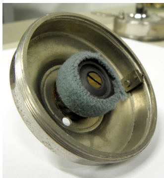
Kuva 15. Seinäpuhelimen 345 luurin mikrofoniosa. Sinisen värinen huoparengas on näkyvä kuvassa. (Ranta 2011.)
