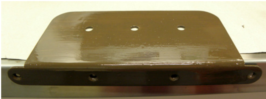
Kuva 27. Paristoa paikallaan pitävä metallilevy. Metallilevy on maalattu kertaalleen. (Ranta 2011.)
