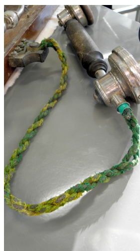
Kuva 35. Puhelinlanka. Puhelinlangan vihreä väri on haalistunut ja lanka kulunut. (Ranta 2011.)
