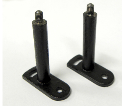
Kuva 23. Soittokellojen pidikkeet suojausten jälkeen. (Ranta 2011.)
