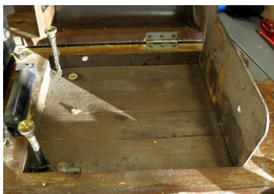
Kuva 25. Seinäpuhelimen takaseinän sisäpuoli, jossa paristo on sijainnut. (Ranta 2011.)
