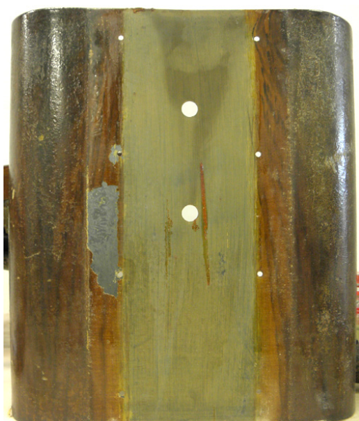
Kuva 20. ”Pulpetin” peltiosa. Keskeltä otettu pois puinen aihio, jossa tavaramerkki on. Ooteraus on säilynyt hyvin puu aihion alla. (Ranta 2011.)
