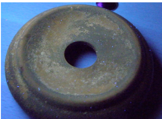
Kuva 28. Luurin kuulokeosa UV-valon alla. Pinta fluoresoi oranssina viitaten sellakkaan. (Ranta 2011.)
