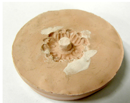
Kuva 62. Kipsimuotti tinavalun valamista varten.
