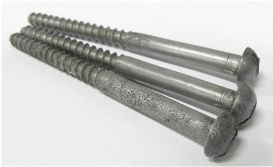
Kuva 30. Kolme seinäpuhelimien linssikantaista kiinnitysruuvia. (Ranta 2011.)
