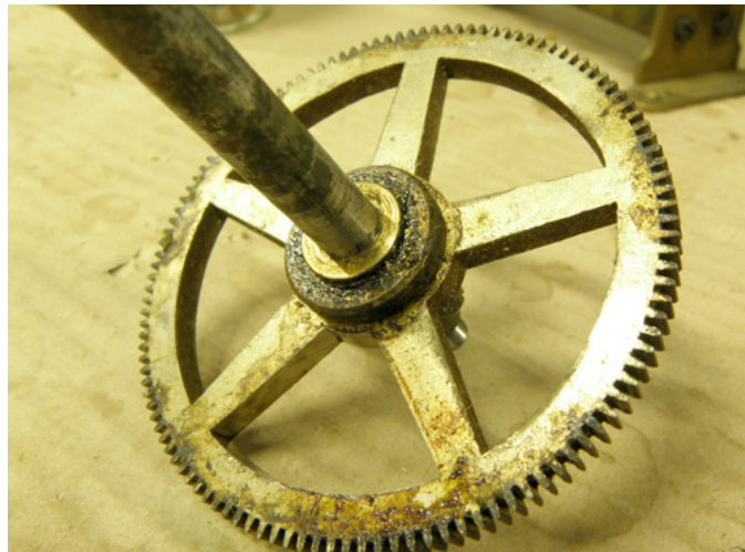
Kuva 24. Seinäpuhelimen veivin. Veivin oli melko öljyinen ja likainen. (Ranta 2011.)
