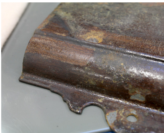
Kuva 12. Soittokellokoneen kellopelti. Ootrausta rapsutettu esiin. (Ranta 2011.)
