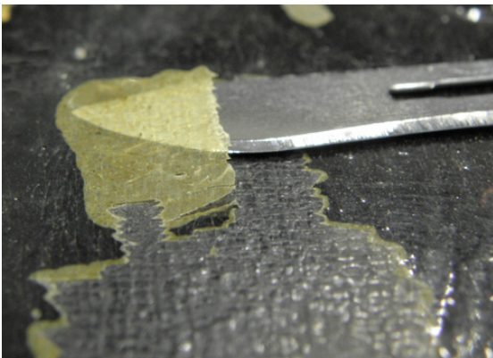
Kuva 10. Seinäpuhelimien keskiosan mustan maalin päällä oleva öljypohjainen lakka lähti helposti kirurginveitsellä. (Ranta 2011.)
