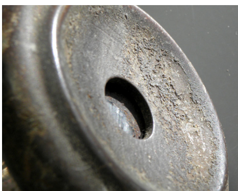
Kuva 34. Luurin kuulokeosan pinta on melko pahoin vaurioitunut. (Ranta 2011.)
