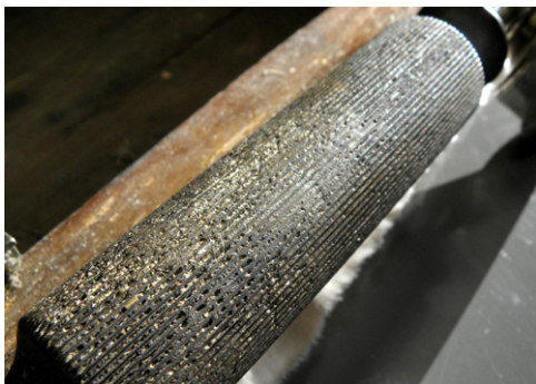
Kuva 32. Luurin kädensija. Urat ovat täyttyneet liasta. (Ranta 2011.)
