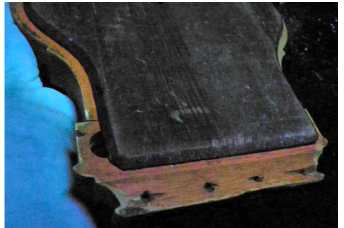
Kuva 9. Seinäpuhelimien takaa yläosa fluoresoi oranssina. (Ranta 2011.)
