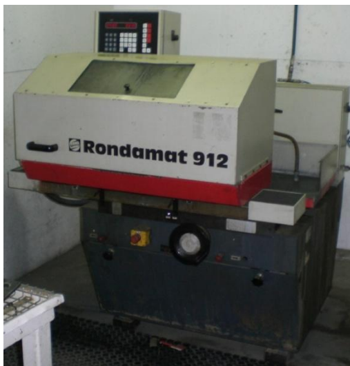
Kuvio 22. Weing Rondamat 912 automaattinen teroituskone suorien teräkuttereiden teroitukseen.
