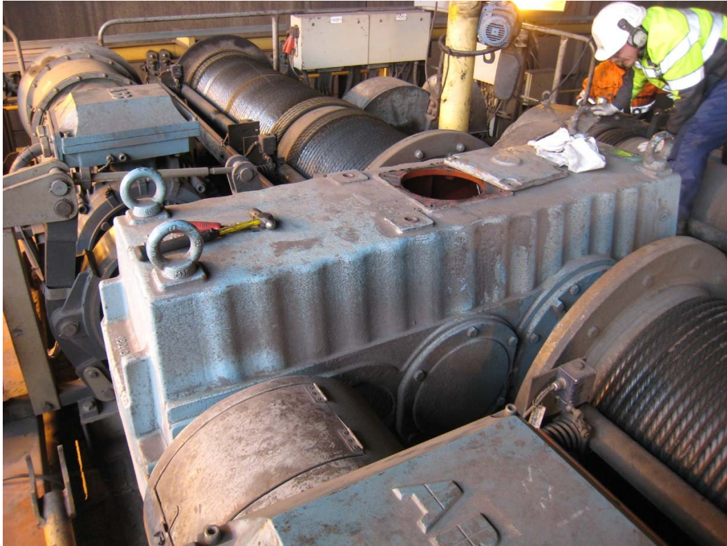
KUVA 7. Nostokoneisto ja avattu nostokoneiston vaihde
