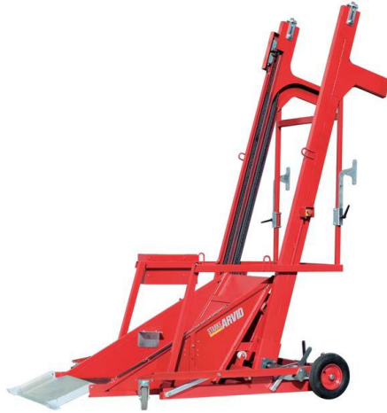
Kuva 9 Konttiin kiinnitettävä astiathyjennin. Kuva: Starke Arvid
