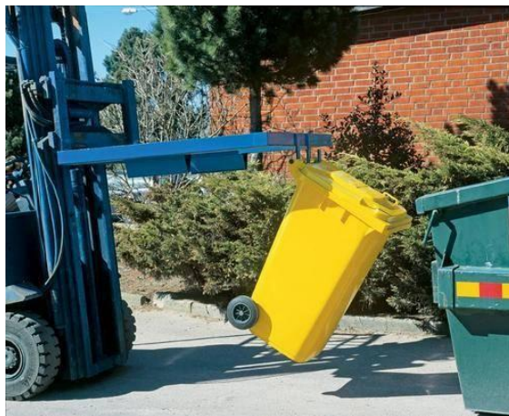
Kuva 8 Astian tyhjennys trukin lisälaitteen avulla. Kuva: Witre
