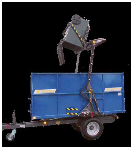
Kuva 10 Ruotsalaisen K-vaunun tyhjennyslaite peräkärriin asennettuna. Kuva: K-vagnen
