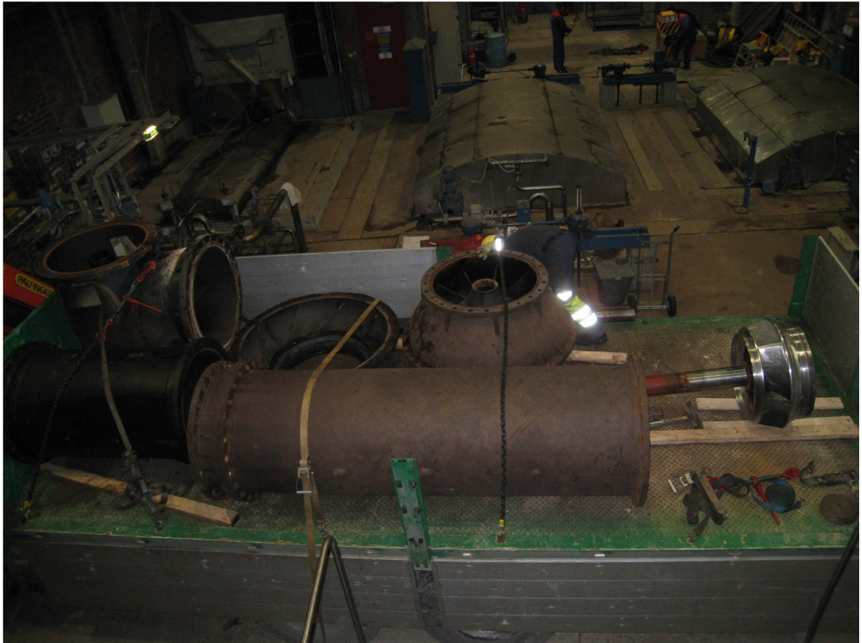
Pumppu osineen lastattuna kuorma-auton lavalle.
