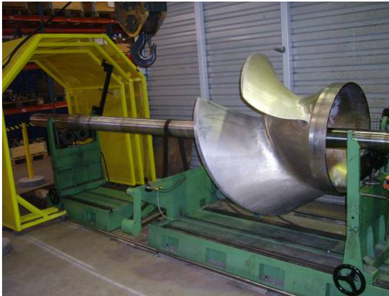
Kuva 127. Akselin ja impellerin tasapainotus(kuva: Patria)
