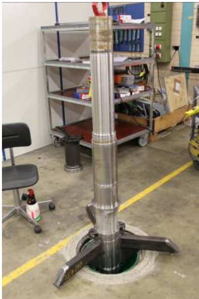
Kuva 33. Impelleri on irrotettu hydraulipuristimen avulla akselilta.(kuva: Patria)
