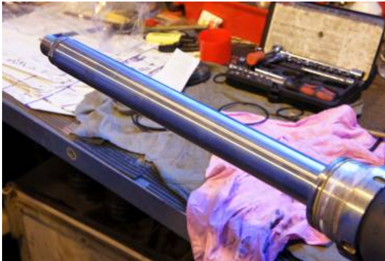
Kuva 104. Ohjaussylinterin mäntä asennetaan ohjaussylinteriin tiivisteiden vaihdon jälkeen.
