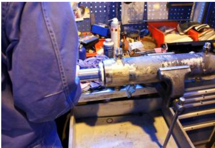
Kuva 97. Ohjaussylinterin mäntä asennetaan ohjaussylinteriin. Männän tiivisteisiin laitetaan hydraulikkaöljyä ennen asennusta.
