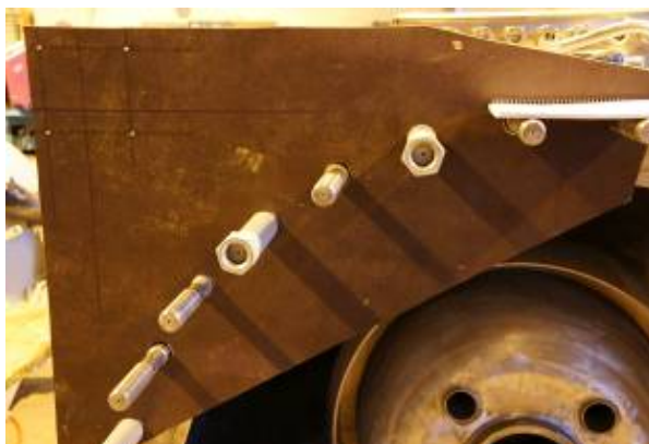
Kuva 111. Ohjaussiivistökammiota vasten kiinnitetään levy, joka simuloi peräpeiliä, jossa on hydrauliputkien läpiviennit. Etäisyys läpivienteihin on mitattu aluksesta imukanavan kehältä, jotta putkien mitoitus ja muotoilu on mahdollista tehdä korjaamolla.
