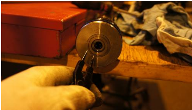
Kuva 24. Männän päästä irrotetaan lukkorengas lukkorengaspihdeillä ja sen takana oleva takaisinkytkennän potentiometri poistetaan. Myös männän tiivisterenkaat irrotetaan.
