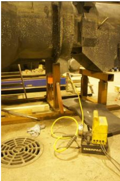
Kuva 10. Niveltapin ulosveto. Kuvassa hydraulisen puristimen toimilaite on kiinnitettyinä hydraulipuristimeen.
