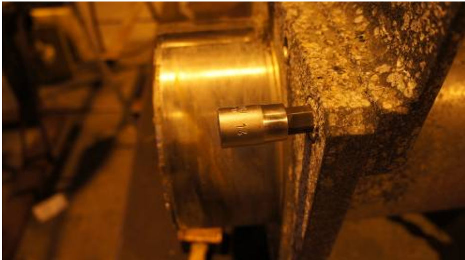
Kuva 16. Kääntövarren irrotuksen jälkeen suunnanvaihtolaitteen laakeripesän kuusiokolopultit irrotetaan 14 mm kuusiokoloavaimella.
