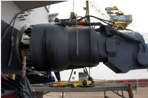
Kuva 133. Vesisuihkulaiteen pinnapultit viedään peräpeilin läpivienneistä sisään. Tiivistemassaa tulee laittaa peräpeilin sekä ohjaussiivistökammion tasopinnoille.
