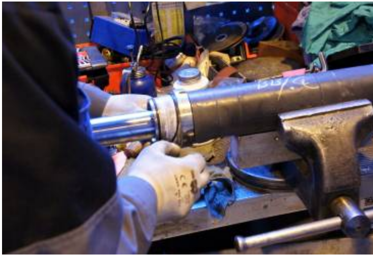
Kuva 106. Ohjausholkin o-renkaat vaihdetaan uusiin.
