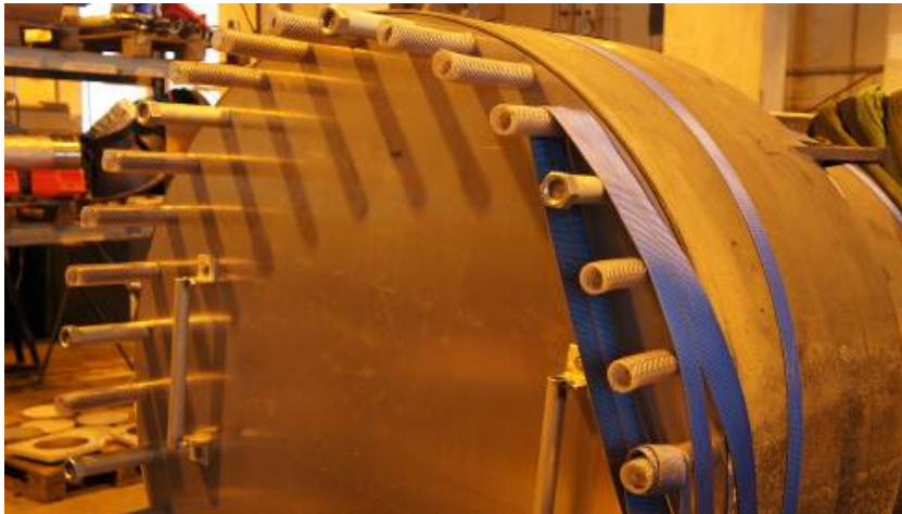
Kuva 51. Ohjaussiivistökammion sisäpinnat on suojattu hiekkapuhallukselta ja pohjamaalaukselta. Ohjaussiivistökammio kiinnitetään pukkiin kuormaliinoilla kuljetusta varten.
