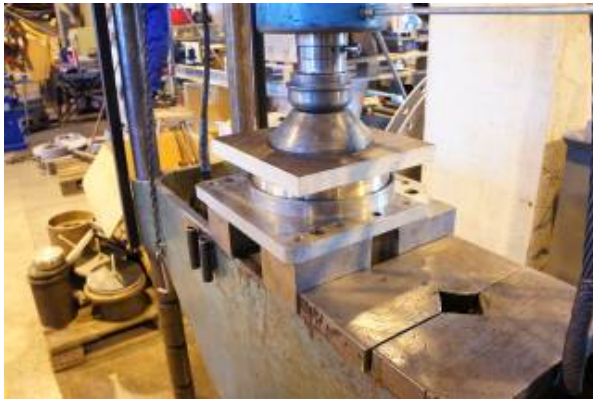
Kuva 64. Suunnanvaihtolaitteen laakeriholkki asennetaan laakeripesään. Laakeriholkin painamisessa käytetään puulevyä välikappaleena, jotta laakeri ei vaurioituisi.
