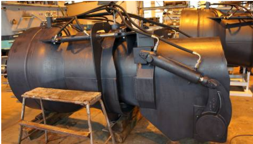
Kuva 125. Mustalla Triluxilla pintamaalatut vesisuihkulaitteet. Olosuhteista riippuen vesisuihkulaite maalataan joko ruiskulla tai siveltimillä.
