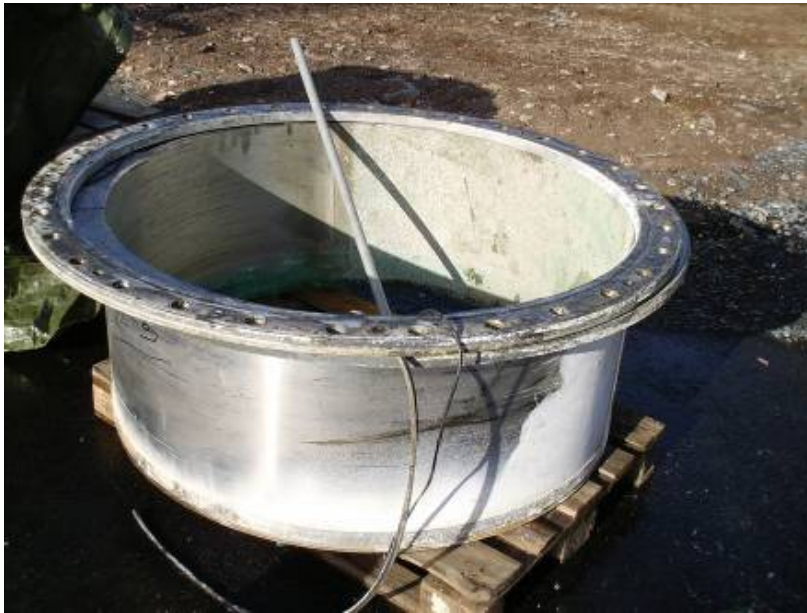
Kuva 38. Imukanavan sisään tuleva väliholkki ja peräpeiliä vasten tuleva vasterengas puhdistetaan.
