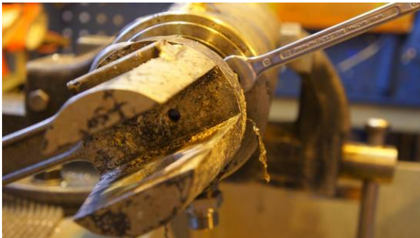
Kuva 20. Männänvarren haarukka ja jäänmurtorengas irrotetaan.
