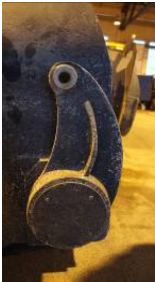
Kuva 13. Suunnanvaihtolaitteen kääntövarsista irrotetaan pyöreä päätykansi.
