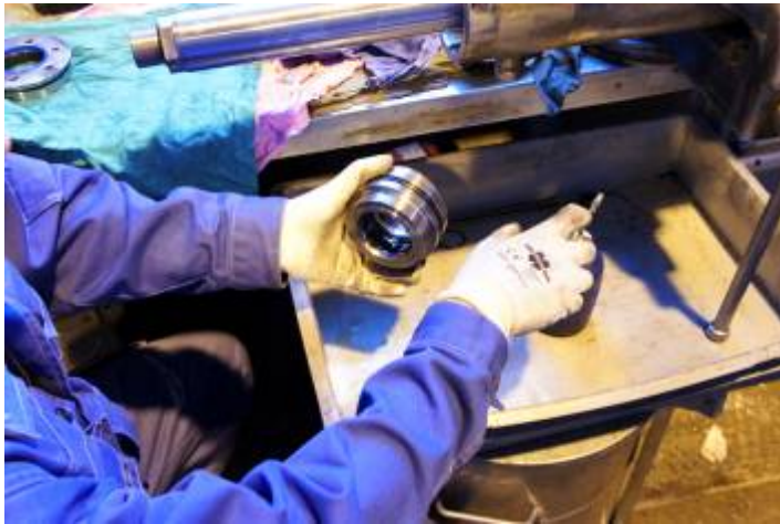
Kuva 98. Ohjaussylinterin ohjausholkkiin laitetaan hydraulioöljyä ennen asennusta.
