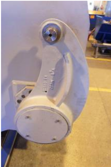
Kuva 93. Suunnanvaihtolaitteen kääntövarsi asennettuna
