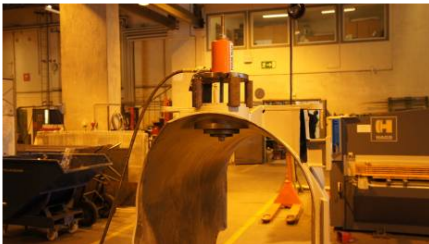
Kuva 58. Suulakkeen laakeriholkin ulosveto hydraulipuristimen avulla. Hydraulipuristin asetetaan jalustalle ja sen läpi viedään kierretanko, joka on kiinnitetty mutterilla ja aluslevyillä laakerin alapuolelle ja puristimen yläpuolelle.
