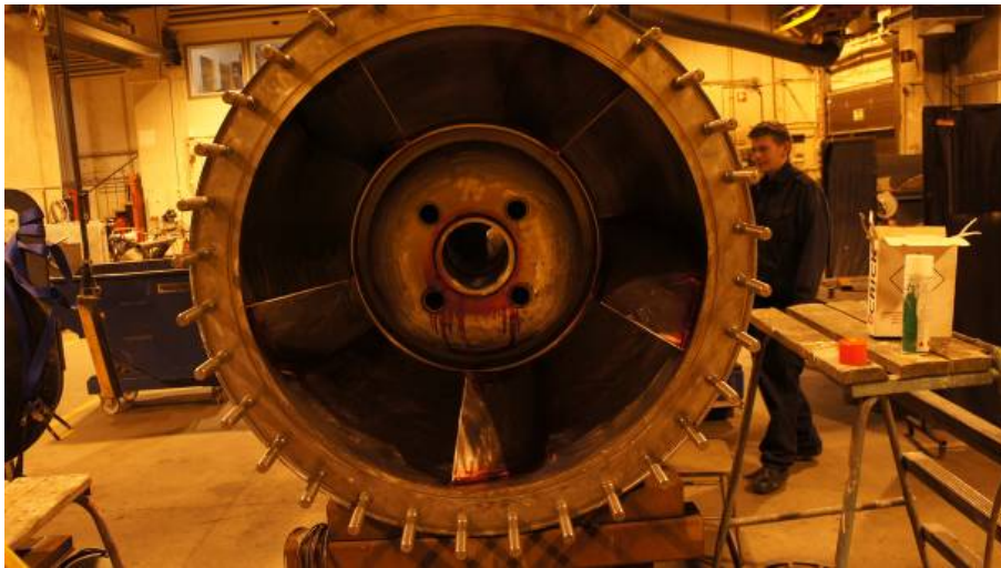
Kuva 44. Tunkeumavärin annetaan vaikuttaa ohjaussiivistössä n. 30 min.
