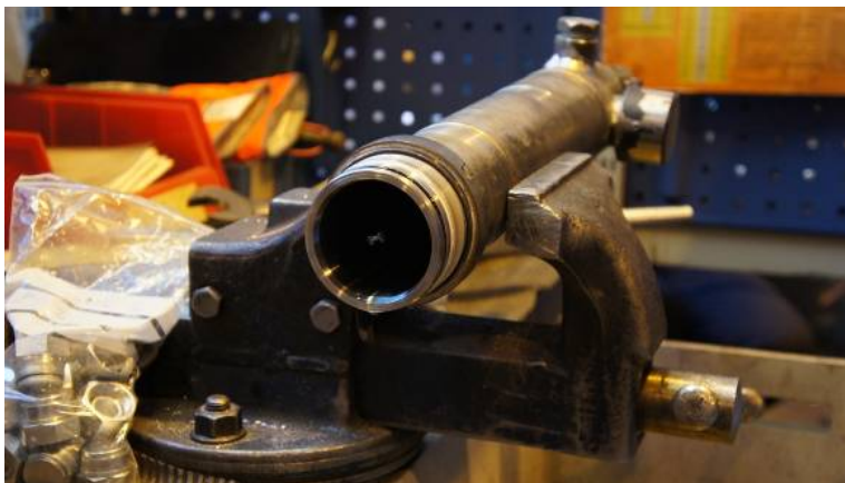
Kuva 28. Suulakkeen ohjaussylinteri, josta mäntä on irrotettu
