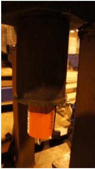
Kuva 9. Suulakkeen alapuoliseen niveltappiin on kiinnitetty ulosvetoholkki ja hydraulinen puristin.
