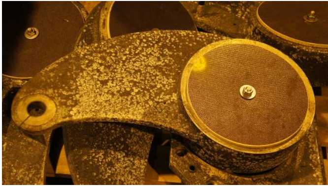
Kuva 48. Suunnanvaihtolaitteen kääntövarret suojataan.
