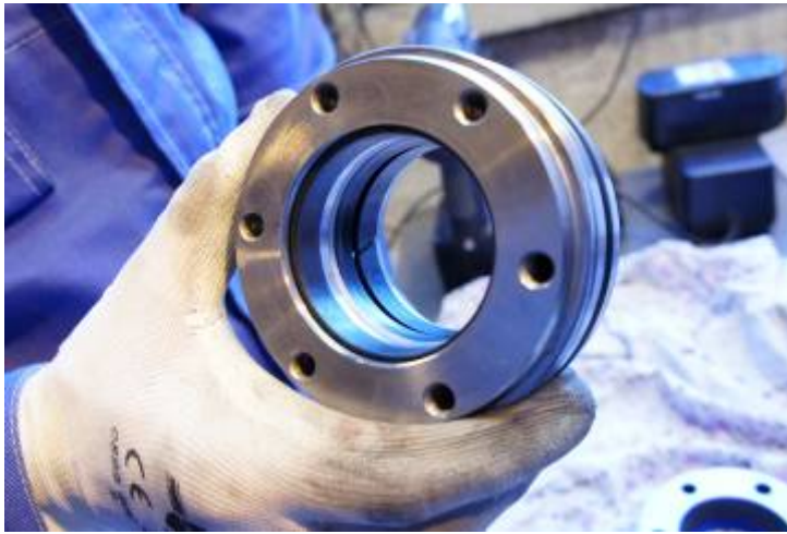
Kuva 96. Ohjausholkkiin vaihdetaan tiivisteet.
