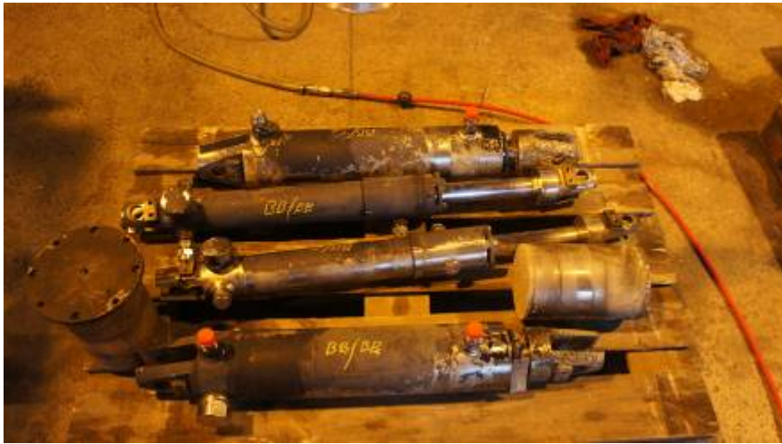
Kuva 6. Irrotettuihin ohjaussylintereihin tehdään paikkamerkintä.
