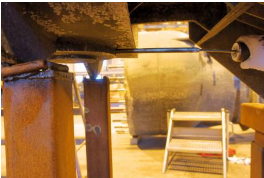
Kuva 7. Ohjaussuulakkeen alapuolisen niveltapin lukitustapin irrotus liukuvasaran avulla.
