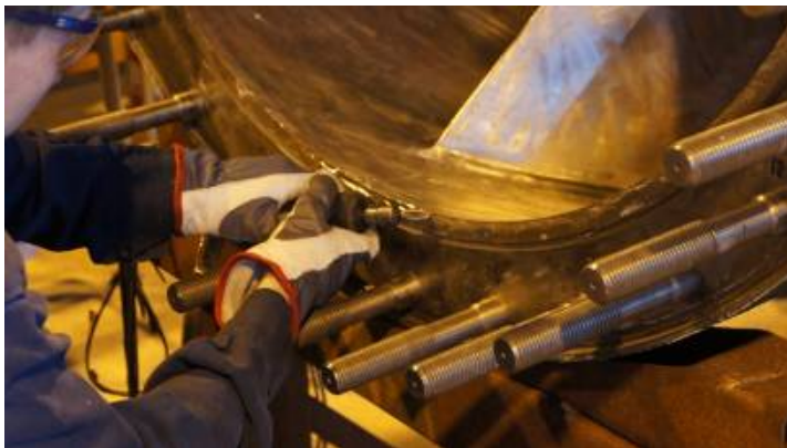
Kuva 72. Syöpymät poistetaan pyörivällä viilalla.
