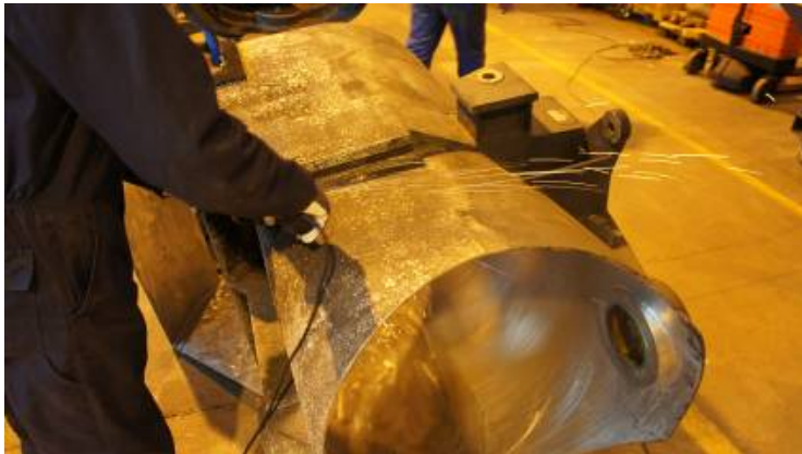
Kuva 31. Suulakkeesta poistetaan niveltapin laakerirasvaputket kulmahiomakoneella.
