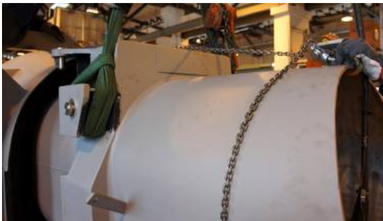
Kuva 79. Ohjaussuulaketta asetellaan kohdilleen nostotaljaa kiristämällä. Suulake on oikealla kohdalla, kun niveltapin reiät ovat kohdakkain.
