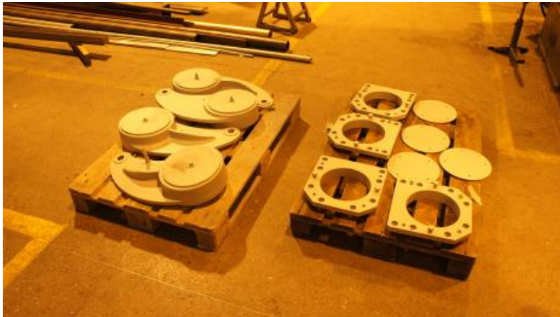
Kuva 54. Kääntövarret hiekkapuhallettuina ja pohjamaalattuina
