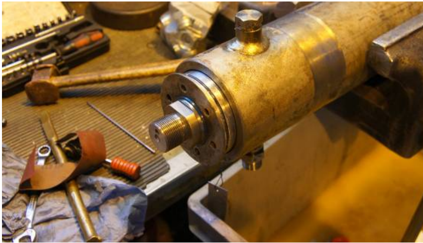
Kuva 21. Ohjaussylinterin suojakansi irrotetaan.
