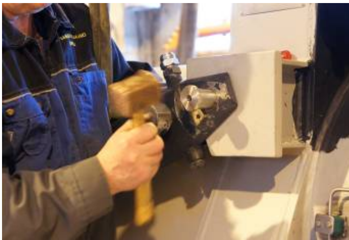
Kuva 111. Suunnanvaihtolaitteen ohjaussylinterin staattiseen päähän lyödään kiinnitystappi.
