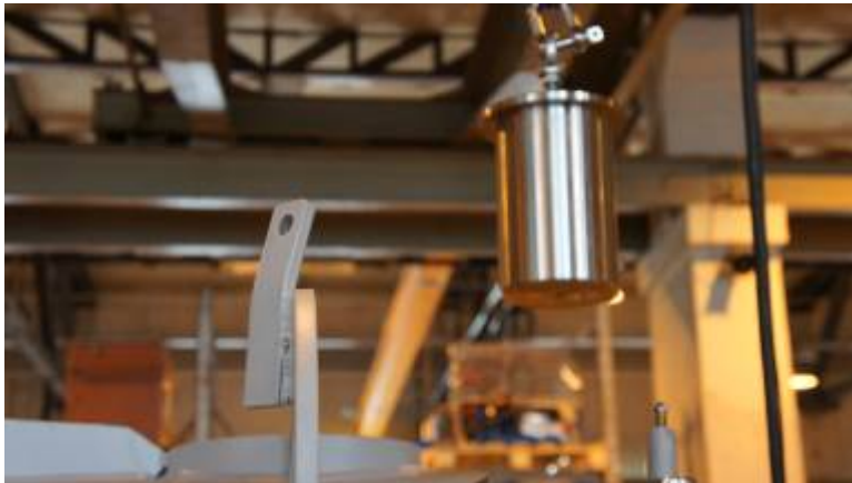
Kuva 82. Nivel tappi nostetaan nosturin avulla kohdilleen.
