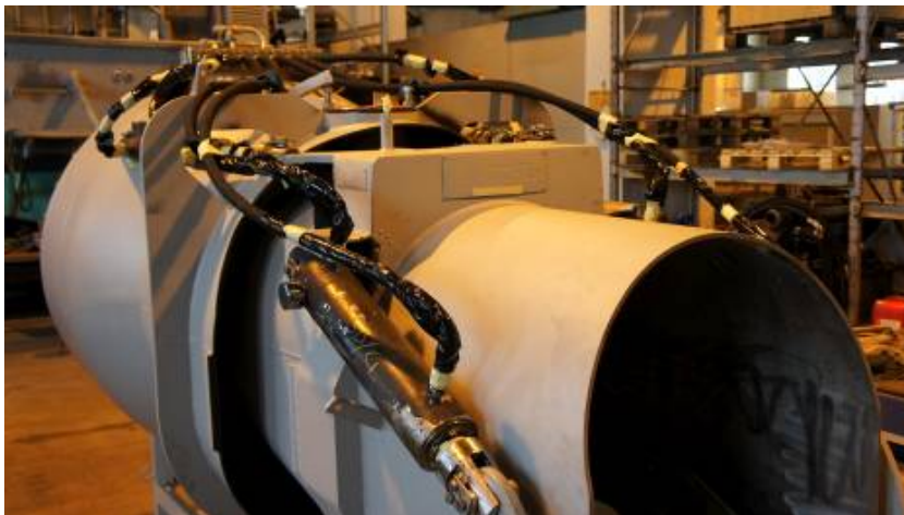
Kuva 124. Pintamaalausta varten suojattu vesisuihkulaitteisto
