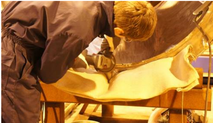
Kuva 75. Hitsaussauma tasoitetaan kulmahiomakoneella.
