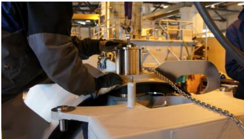
Kuva 83. Nivel tappi asennetaan paikoilleen. Tarvittaessa nivel tappia voidaan naputella paikoilleen kupari- tai lyijylekalla. Asennettaessa on syytä kiinnittää huomiota siihen, että nivel tappi asennetaan laakeriholkkiin suoraan ja ilman kohtuutonta väkivaltaa.
