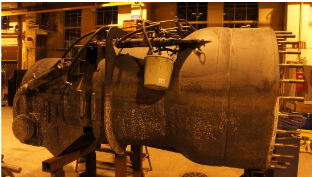
Kuva 1. Hydrauliiikkaletkuista ja ohjaussylintereistä valutetaan hydrauliiikkaöljyt astiaan
