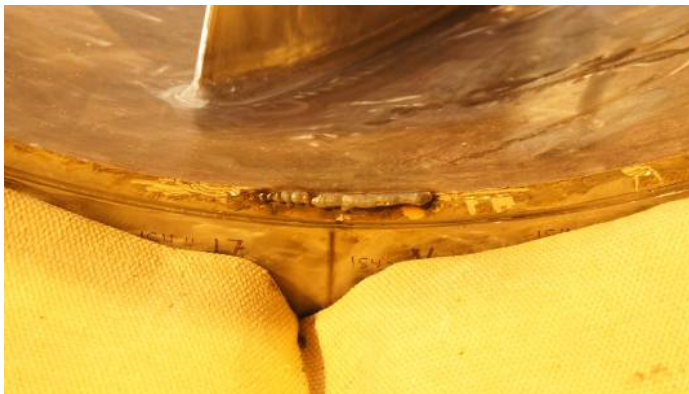
Kuva 74. Viilattuun railoon hitsataan sauma.
