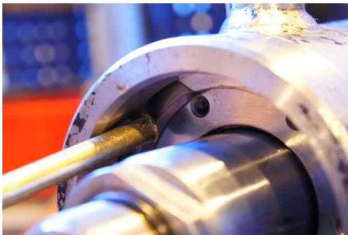
Kuva 100. Ohjausholkki lukitaan asentamalla kolmiosainen lukitusrenkas lukitusrenkaan uraan.
