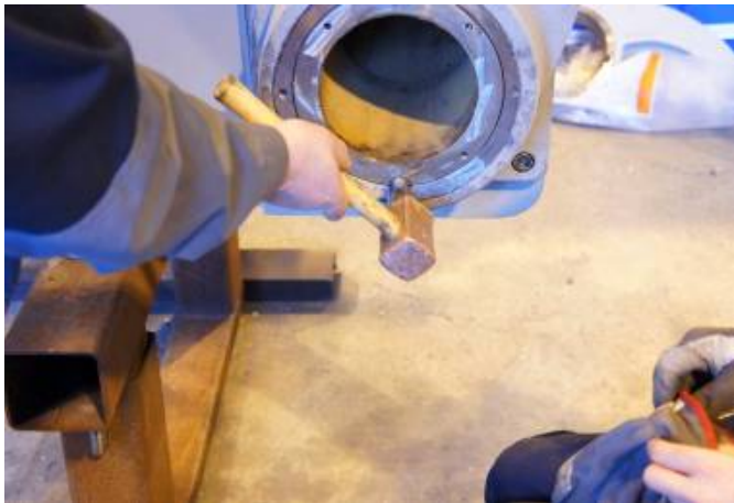
Kuva 92. Numeroidut lukitustapit koputellaan kuparilekalla akselin ja kääntövarren väliin.
