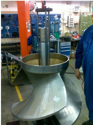
Kuva 32. Akselille on tehty lattiaan reikä, jossa on tuki akselin pitämiseksi pystyasennossa. Akselin pään ja ulosvetoraudan väliin laitetaan hydraulinen puristin impellerin ulosvetoa varten.(kuva: Patria)
