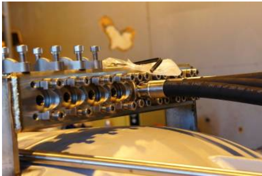
Kuva 116. Mitoitetut hydrauliletkut kiinnitetään hydraulijakotukin laippaliittimiin. Hydrauliletkujen mitoituksessa on tärkeää mitoittaa letkut siten, että ohjaussuulake työnnetään käsin vasempaan ja oikeaan ääriasentoon. Samalla mitat otetaan ohjaussylintereiltä jakotukille.
