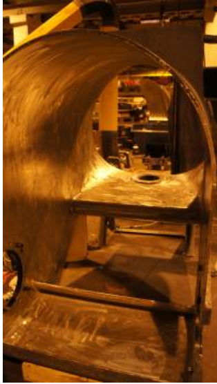
Kuva 42. Ohjaussuulakkeen sisäpinnat on puhdistettu merirokosta.
