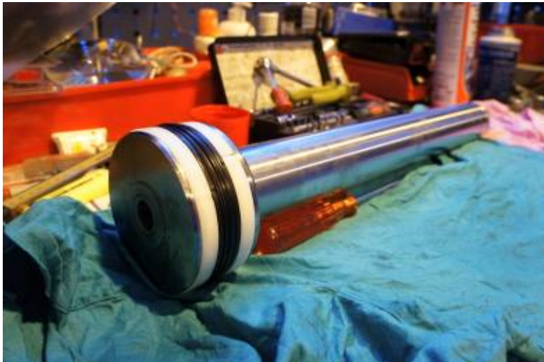
Kuva 94. Suunnanvaihtolaitteen ohjaussylinterin mäntä, jonka varsi on uudelleen pinnoitettu. Mäntään vaihdetaan uudet tiivisteet.
