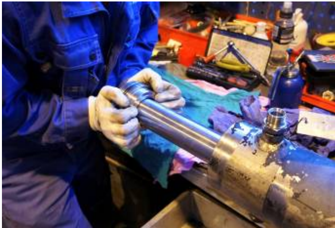
Kuva 99. Ohjausholkki asennetaan männänvartta pitkin ohjaussylinteriin.
