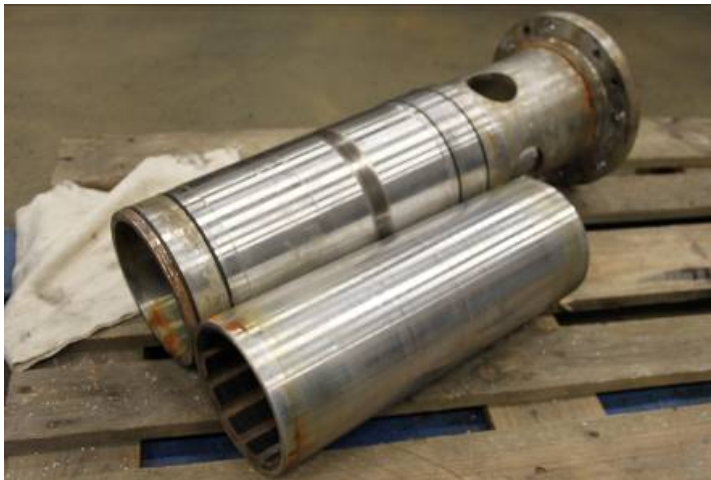
Kuva 36. Laakerihylsyn sisästä irrotetaan metalli- tai komposiittikuorinen Thordon-tyyppinen kumilaakeri. (kuva: Patria)
