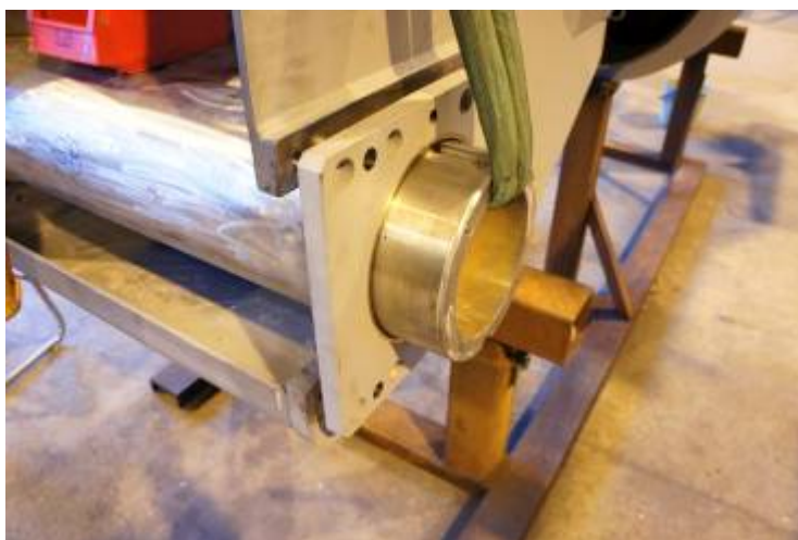
Kuva 89. Suunnanvaihtolaite nostetaan kohdilleen nosturilla.
