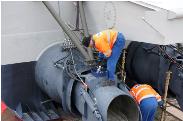
Kuva 134. Tukiputki kiinnitetään pulteilla peräpeilin ja ohjausniveleen välille.
