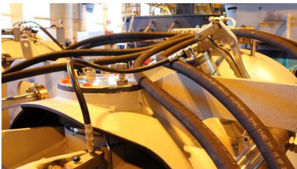
Kuva 121. Niveltapin laakereihin painetaan rasvaa ennen koeponnistusta.
