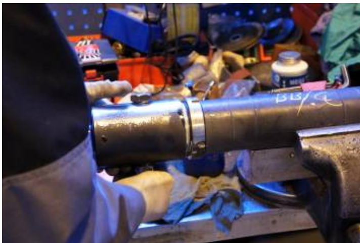
Kuva 107. Ohjausholkki kierretään paikoilleen.
