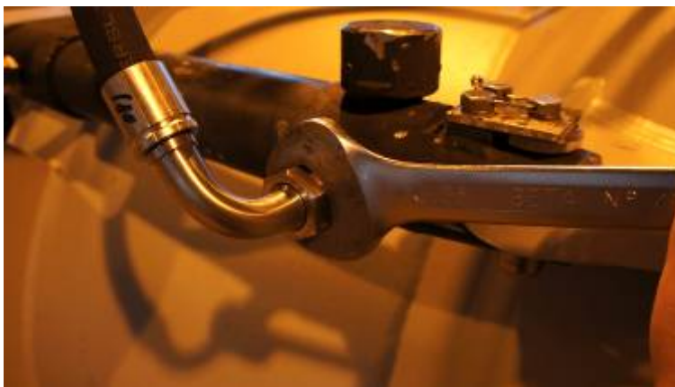
Kuva 117. Hydraulikkaletkut kiinnitetään ohjaussuulakkeen ohjaussylintereihin
