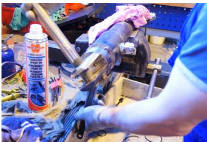
Kuva 109. Männänvarren silmäkekappale (haarukka) kierretään paikoilleen. Lopuksi haarukka lukitaan männänvarteen haarukan päässä olevalla pidätinruuvilla.
