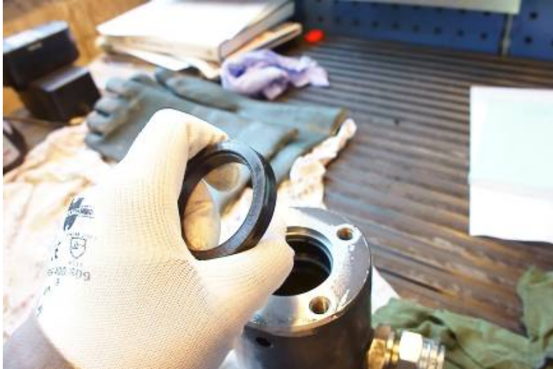
Kuva 102. Tiivisteet vaihdetaan ohjaussylinteriin.
