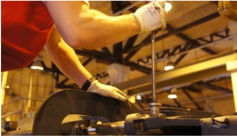
Kuva 4. Ohjaussylintereistä irrotetaan niveltapit liukuvasaran avulla.
