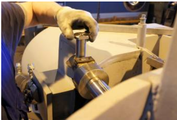
Kuva 113. Ohjaussuulakkeen ohjaussylinterin männänvarsi lukitaan tapilla ohjaussuulakkeeseen.
