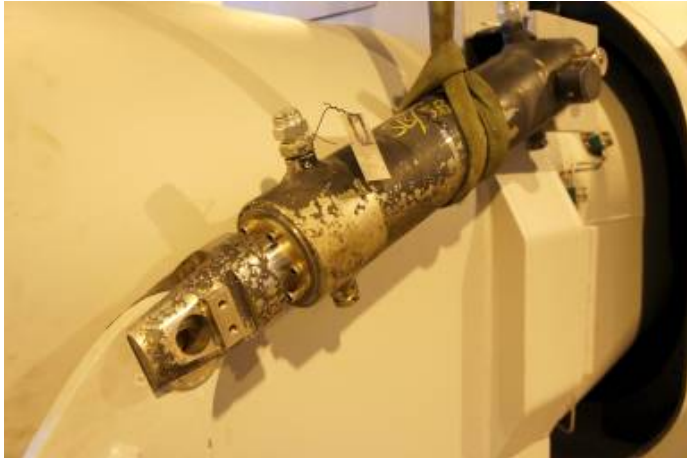
Kuva 110. Suunnanvaihtolaitteen ohjaussylinterin asettelu kääntövarren päähän. Ohjaussylinteri asetellaan nosturin avulla kohdilleen.
