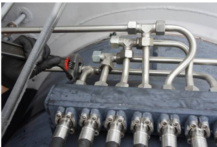
Kuva 135. Hydrauliiikkaputket kiinnitetään jakotukilta perälaitaan.
