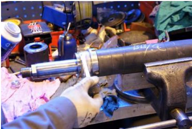
Kuva 105. Kiinnileikkautumisenestoainetta sivellään ohjausholkin kierteisiin.
