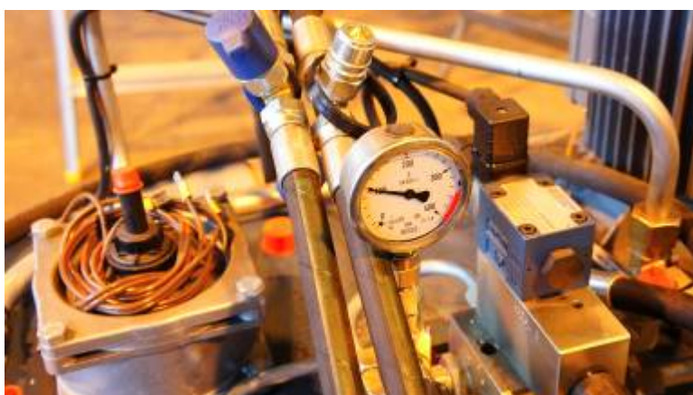
Kuva 122. Ohjaushydrauliikkaa käytetään koeponnistusyksiköllä.
