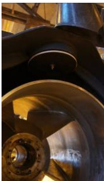
Kuva 46. Ohjaussiivistökammioista suojataan ohjaussuulakkeen niveltappien reiät hiekkapuhallukselta ja pohjamaalaukselta.
