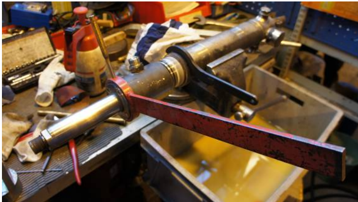
Kuva 27. Männänvarren ohjausholkki irrotetaan kiertämällä sopivan kokoisella lenkkiavaimella vastapäivään. Lenkkiavaimessa (punainen avain) on reikä, jonka läpi laitetaan lukitustappi ohjausholkissa olevaan reikään. Haka-avaimella pidetään vastaan.
