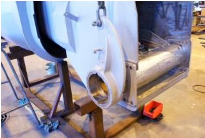
Kuva 91. Kääntövarsi nostetaan nosturilla suunnanvaihtolaitteen akselille.
