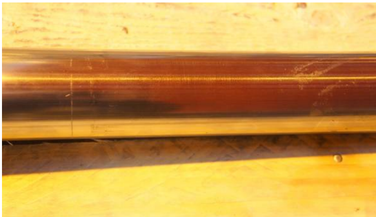
Kuva 30. Vaurioitunut suunnanvaihtolaitteen ohjaussylinterin männänvarsi. Vaurioituneet männänvarret on pinnoitettava uudelleen.
