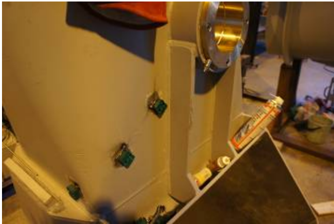
Kuva 68. Rasvapatkien kiinnikkeet hitsataan vesisuihkulaitteen runkoon.
