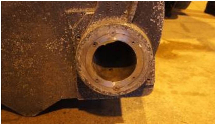
Kuva 14. Suunnanvaihtolaitteen kääntövarsi on lukitustapeilla kiinni akselissa.
