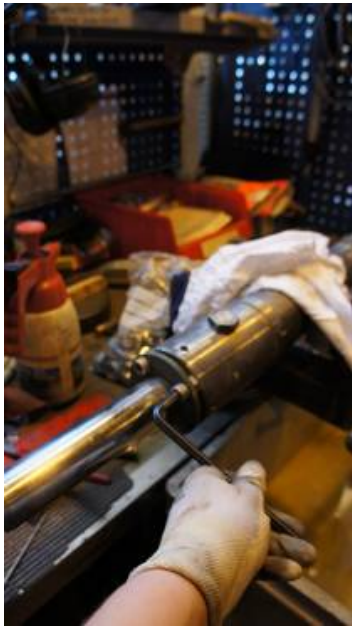
Kuva 26. Jäänmurtorengas irrotetaan kuusiokoloavaimella.
