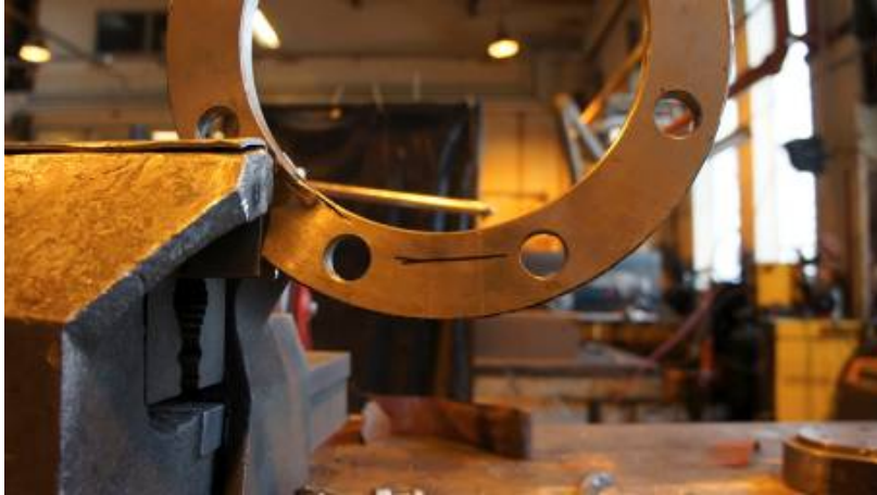
Kuva 87. Ylemmän niveltapin merkitty lukitusrenkas. Lukitusrenkas käytetään paikoillaan pulttien kanssa, jotta nähdään oikea kohta lukitusrenkaaseen tehtävälle kiilauralle.
