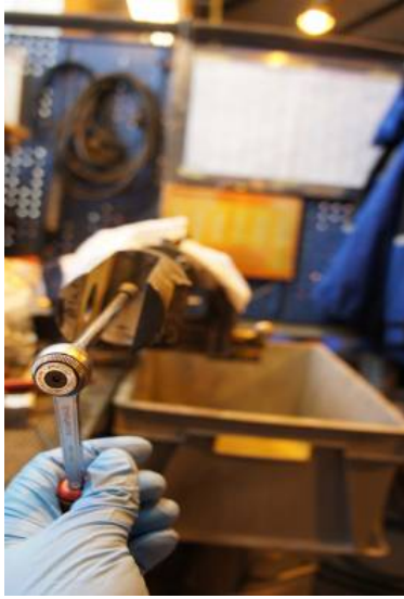
Kuva 25. Pidätinruuvi irrotetaan männänvarren silmäkekappaleesta.
