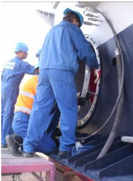
Kuva 129. Vasteterengas asennetaan peräpeiliä vasten.(kuva: merivoimat)
