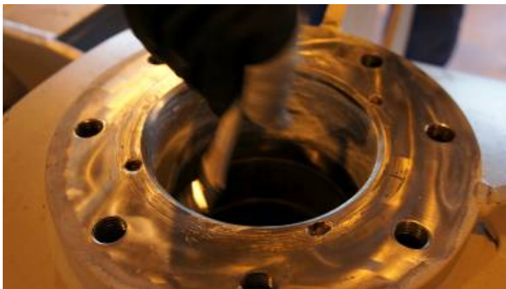
Kuva 81. Ohjaussiivistökammion ylemmän niveltapin läpivientiin sivellään kiinnileikkautumisenestoainetta. Alapuolella ohjaussuulakkeessa sijaitsevaan niveltapin laakeriholkkiin sivellään laakerirasvaa.
