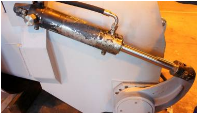
Kuva 123. Suunnanvaihtolaitteen ohjaussylintereihin ajetaan öljyä peruutuspuolelle. Suunnanvaihtolevy nousee suulakkeen sisällä ylös eli peruutussuuntaan.
