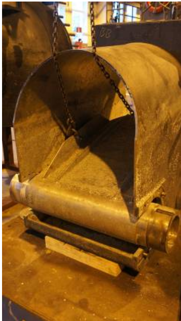
Kuva 18. Suunnanvaihtolaitteen irrotus suulakkeesta nosturin avulla
