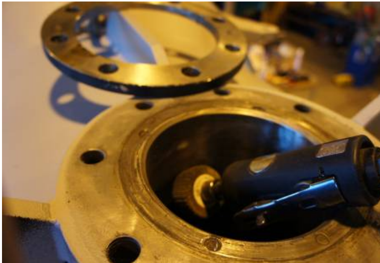
Kuva 80. Ohjaussiivistökammion ylemmän niveltapin läpivienti puhdistetaan pyörivällä hiomalaikalla.
