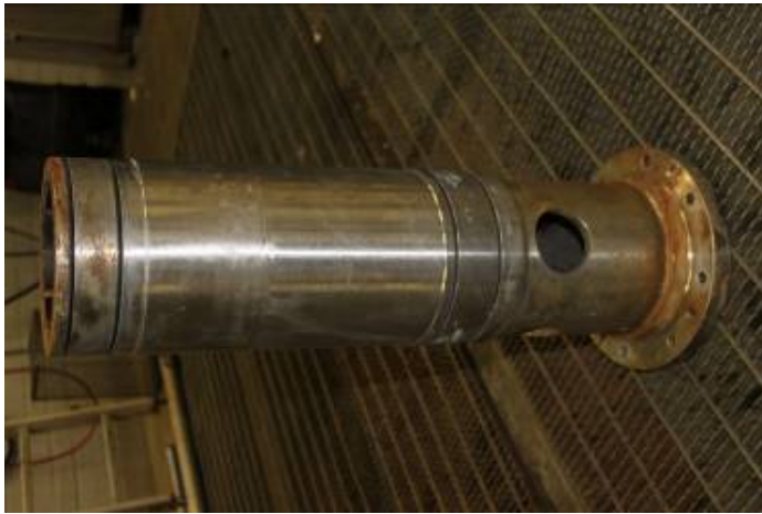
Kuva 35. Thordon-laakeri irrotuksen jälkeen (kuva: Patria)
