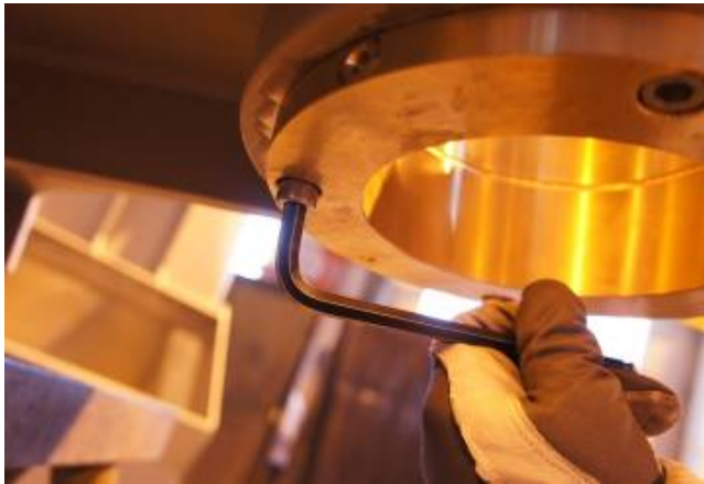
Kuva 62. Ohjaussuulakkeen niveltäpin laakeriholkin kiinnitys kuusiokoloruuveilla laakeripesään. Kuusiokoloruuveihin laitetaan keskikovaa lukitetta.
