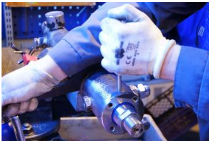
Kuva 108. Ohjausholkki kiristetään. Tämän jälkeen ohjaussylinterin jäänmurtorengas kiinnitetään neljällä kuusiokoloruuvilla.
