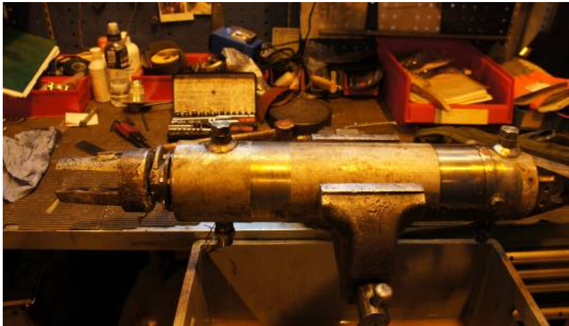
Kuva 19. Suunnanvaihtolaitteen ohjaussylinteri on kiinnitetty ruuvipenkkiin. Hydraulikkaöljyt tyhjennetään alla olevaan kaukaloon.
