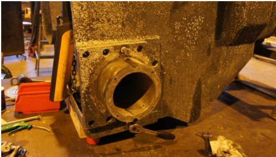
Kuva 17. Kehän pulttien irrotuksen jälkeen laakeripesä vedetään ulos kahta ulosvetopulttia kiertämällä.
