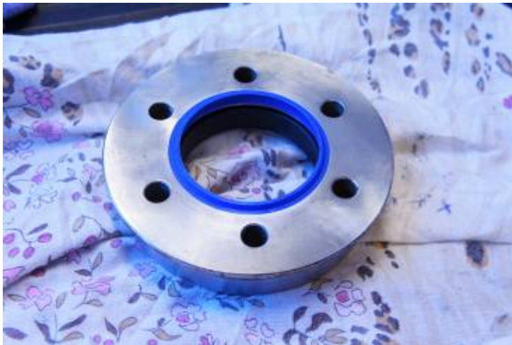
Kuva 95. Ohjaussylinterin suojakanteen vaihdetaan uudet tiivisteet.
