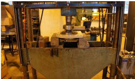
Kuva 63. Laakeriholkki työnnetään ulos hydraulipuristimen avulla. Laakerin ja puristimen välissä voidaan käyttää välikappaleita työntömatkan minimoimiseksi.
