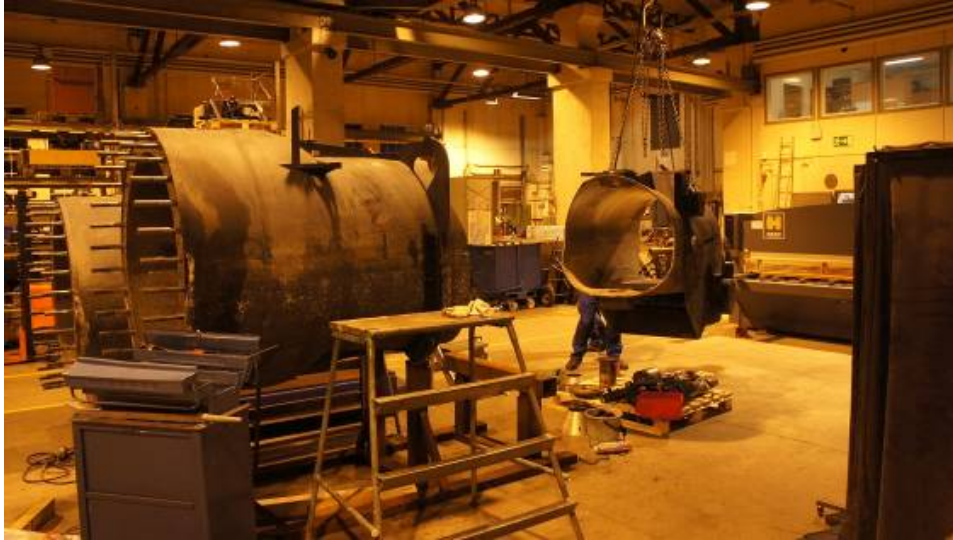
Kuva 12. Ohjaussuulakkeen irrotus ohjaussiivistökammioista nosturin avulla
