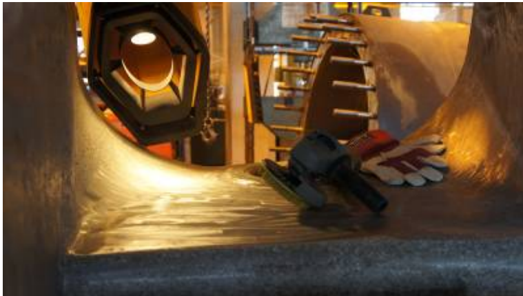
Kuva 40. Kovasti kiinni oleva merirokko poistetaan suulakkeen pinnoilta kulmahiomakoneella. Kuvassa näkyy kulmahiomakone, jossa on kiinni bristle -laikka, joka koostuu muovisista piikeistä.
