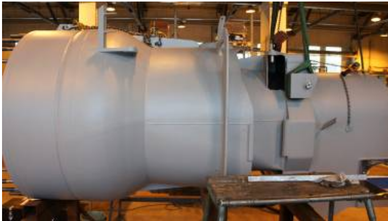
Kuva 78. Ohjaussuulake nostetaan ohjaussiivistökammion suulle nosturin ja nostotaljan avulla.
