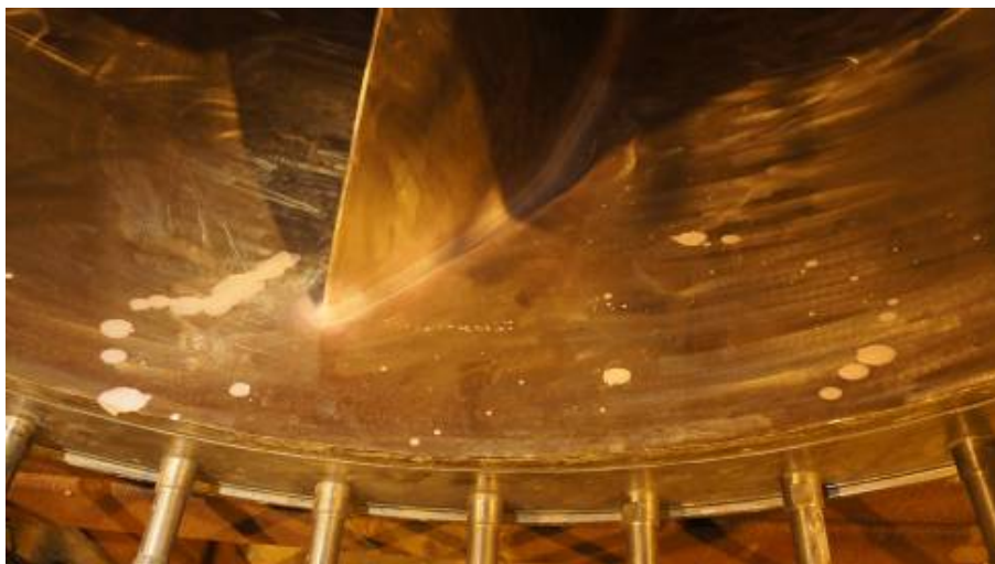
Kuva 45. Kun tunkeumaväri CRICK 120: n on annettu vaikuttaa n. 30 min, se pyyhitään pois, ja päälle suihkutetaan CRICK 130: tä, joka paljastaa mahdolliset säröt. Lopuksi tunkeuma väri pestään vedellä.
