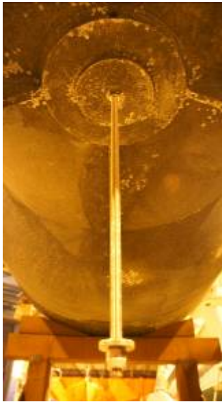
Kuva 8. Ohjaussuulakkeen alapuoliseen niveltappiin kiinnitetään kierretanko, jonka väliin tulee hydraulinen puristin sekä ulosvetoholkki.
