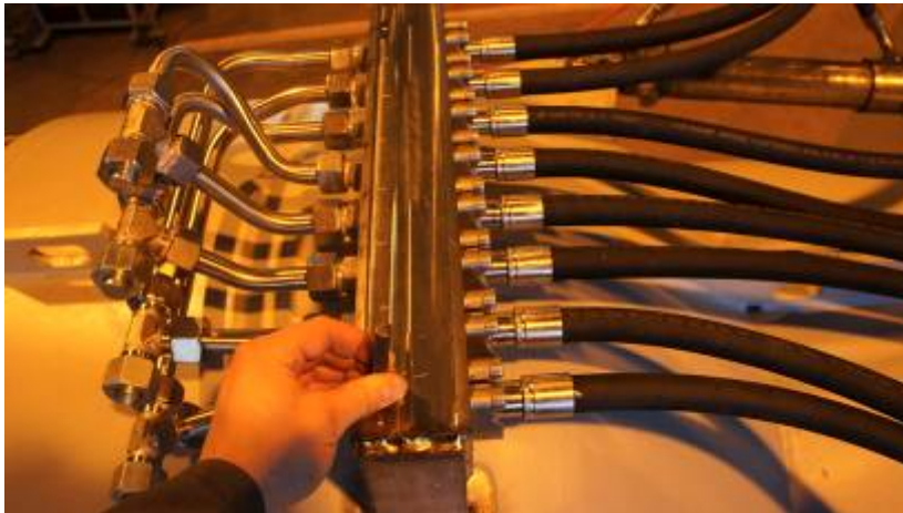
Kuva 119. Jakotukkiin stanssataan jokaisen liitoskohdan suuntamerkintä (o-oikea v-vasen t-taake e-eteen).
