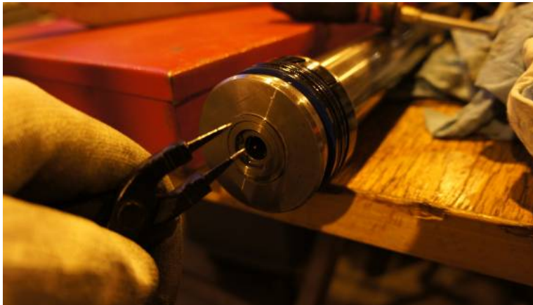
Kuva 29. Takaisinkytkennän potentiometri poistetaan männän päästä eikä sitä enää asenneta takaisin paikoilleen. Takaisinkytkentä muutetaan toisenlaiseksi.
