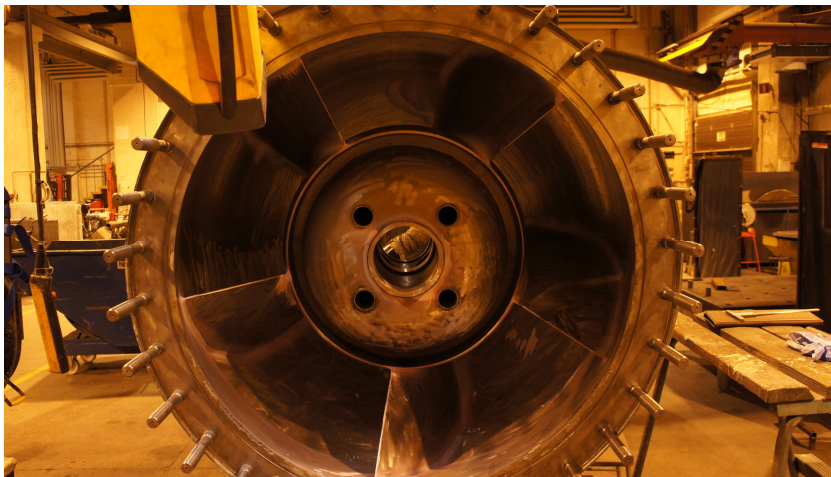
Kuva 5. Riva Calzoni IRC 115:n vesisuihkulaitteen ohjaussiivistökammio
