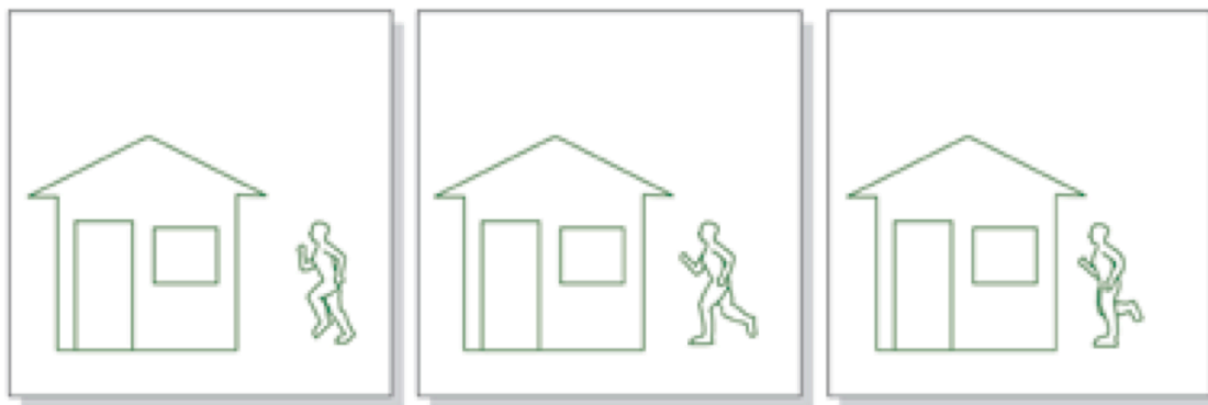
Figur 12. Då man använder Motion JPEG, är alla tre bilderna kodade och skickade som separata bilder (kallas även Image-frames, I-frames) och de är oberoende av varandra. (Axis, 2008)
