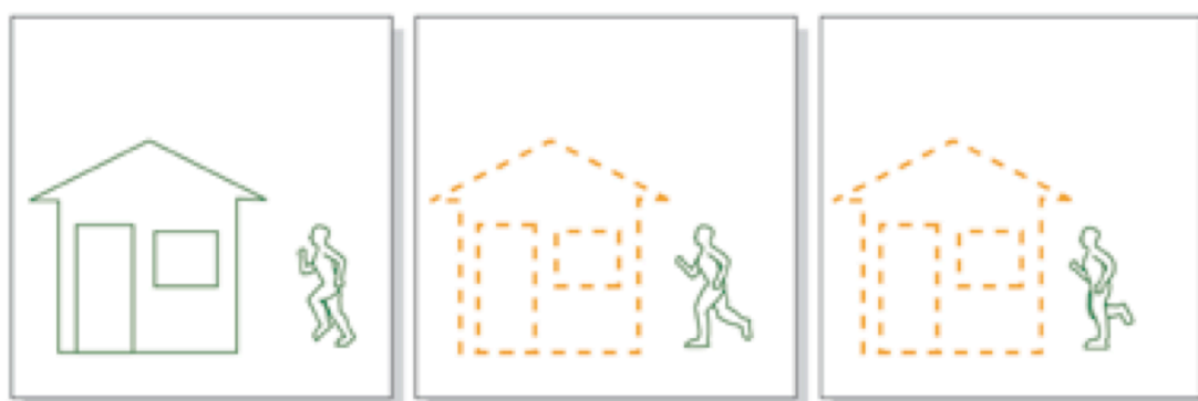
Figur 13. Då man använder s.k. difference koding kodas endast den första rutan (I-frame) i sin helhet. De två följande rutorna (P-frames) refererar till den första rutan för de statiska elementen i bilden, d.v.s. i detta exemplet huset. Endast rörelsen, den springande mannen, kodas med hjälp av rörelsevektorer och minskar på detta vis mängden information som skickas och sparas. (Axis, 2008)
