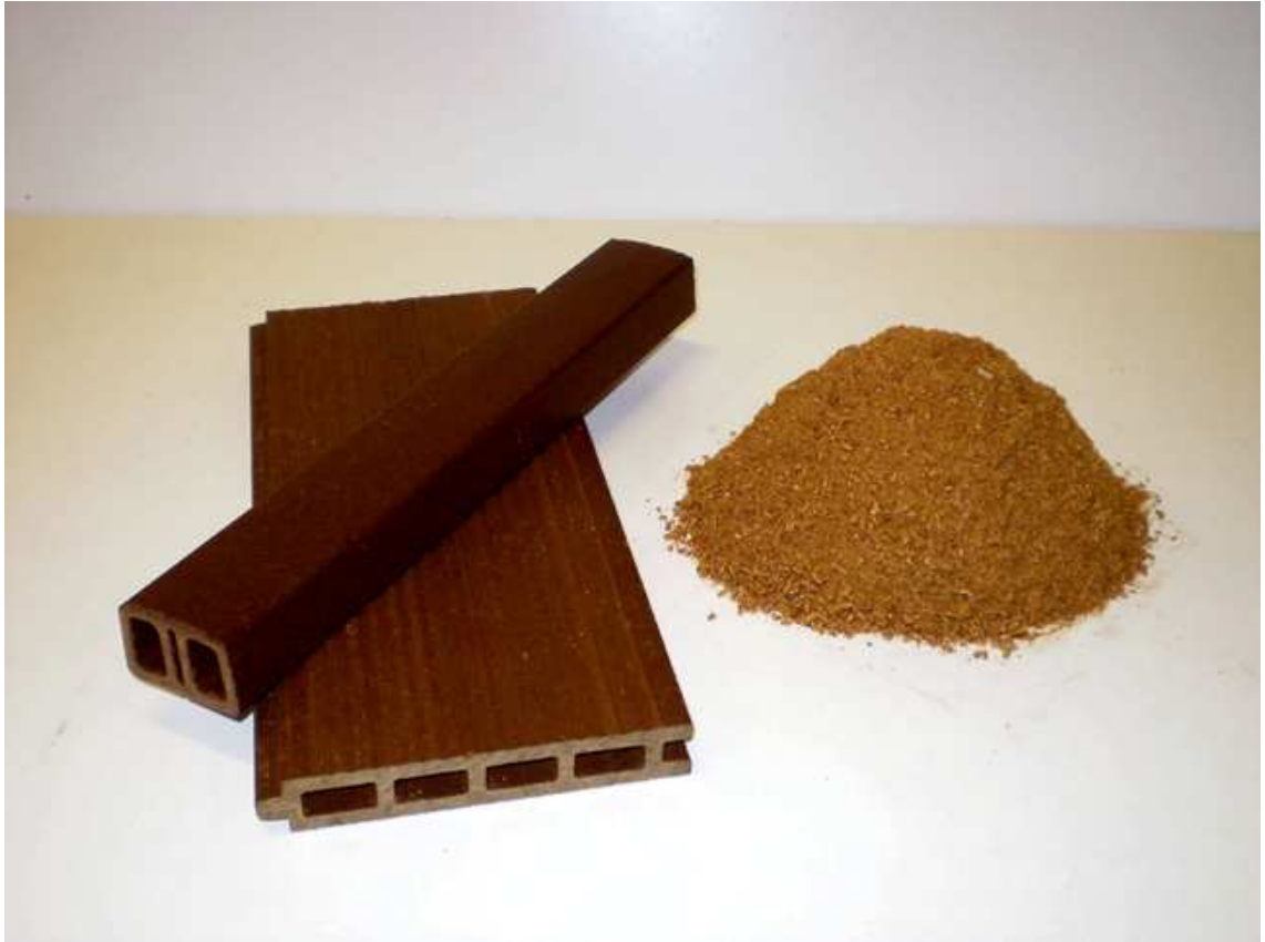
Kuvio 3. Lämpöpuukomposiitti (Knuutinen 2010a).
