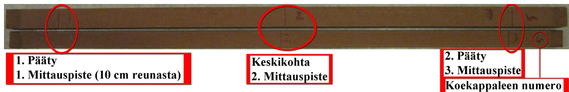
Kuvio 19. Sääkoekappaleiden mittauspisteet.
