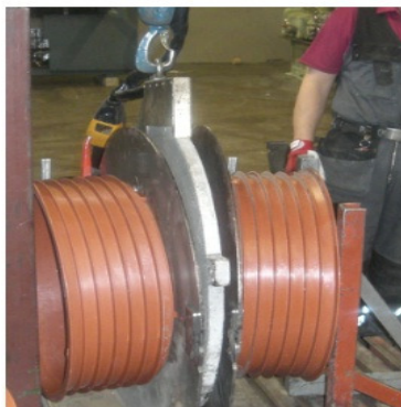
KUVIO 17. Ultra Rib 2 osien liittäminen puskuhitsaus menetelmällä.
