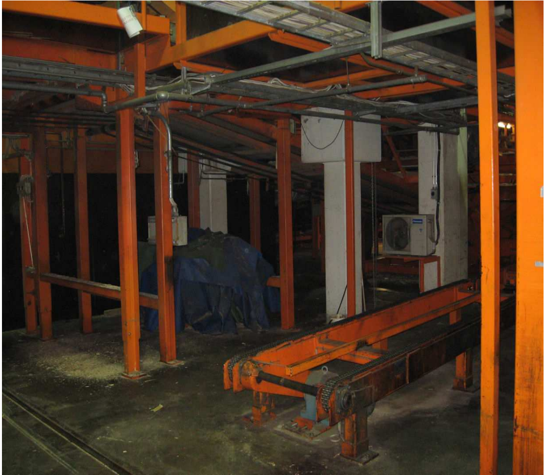
KUVA 2. Ketjukuljettimet varastoalueen traverssille
