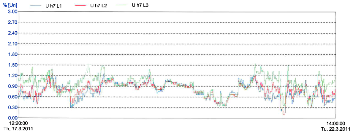
Figur 40. Kurvformen för den 7:e övertonen vid fastighetstransformatorn (Fluke 1744).
