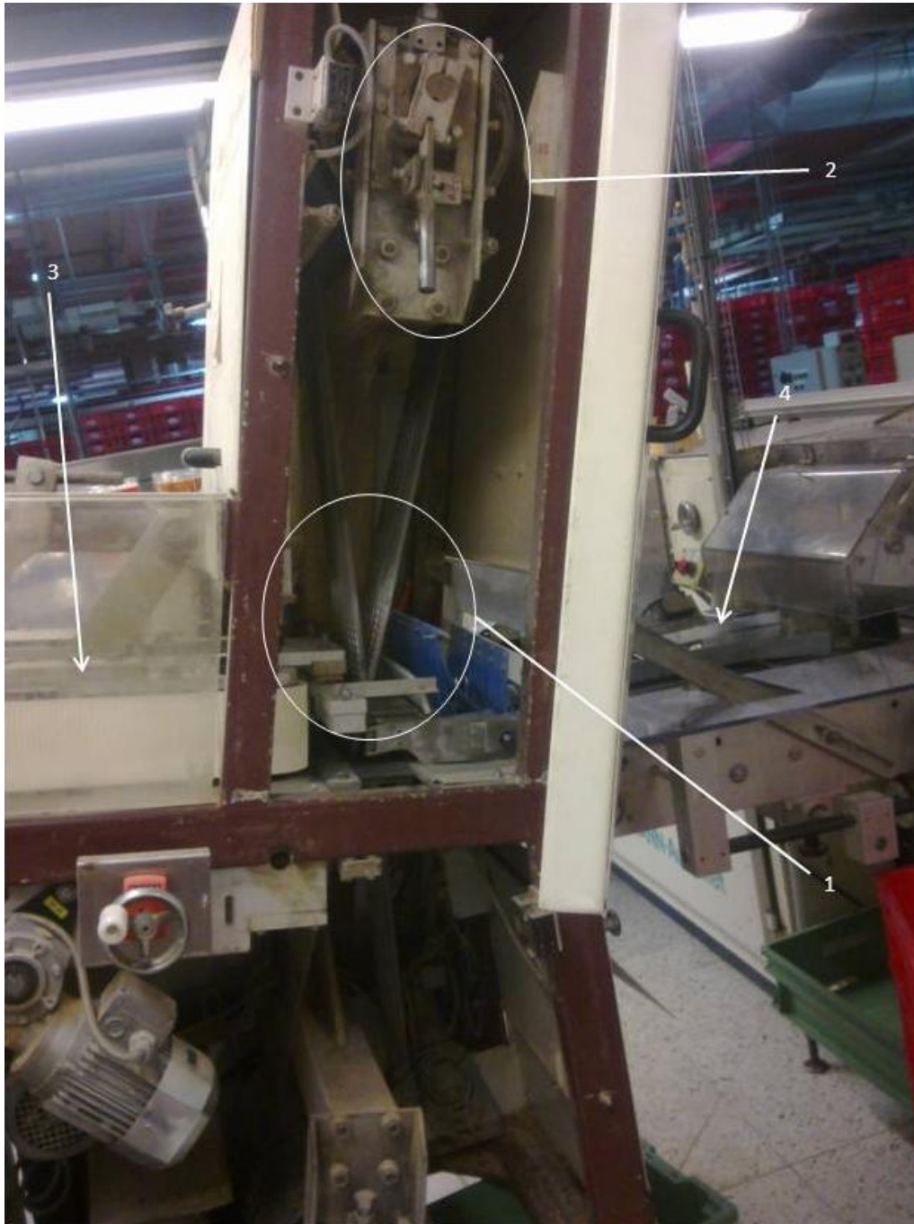
Figur 4. Sågbanden (1) samt deras mekaniska spänningsanordning (2). Produkten in-förs till sågbanden längs intransportbandet som är kaplat med polykarbonat (3) och den färdigt skivade produkten förs bort med uttransportbandet (4).
