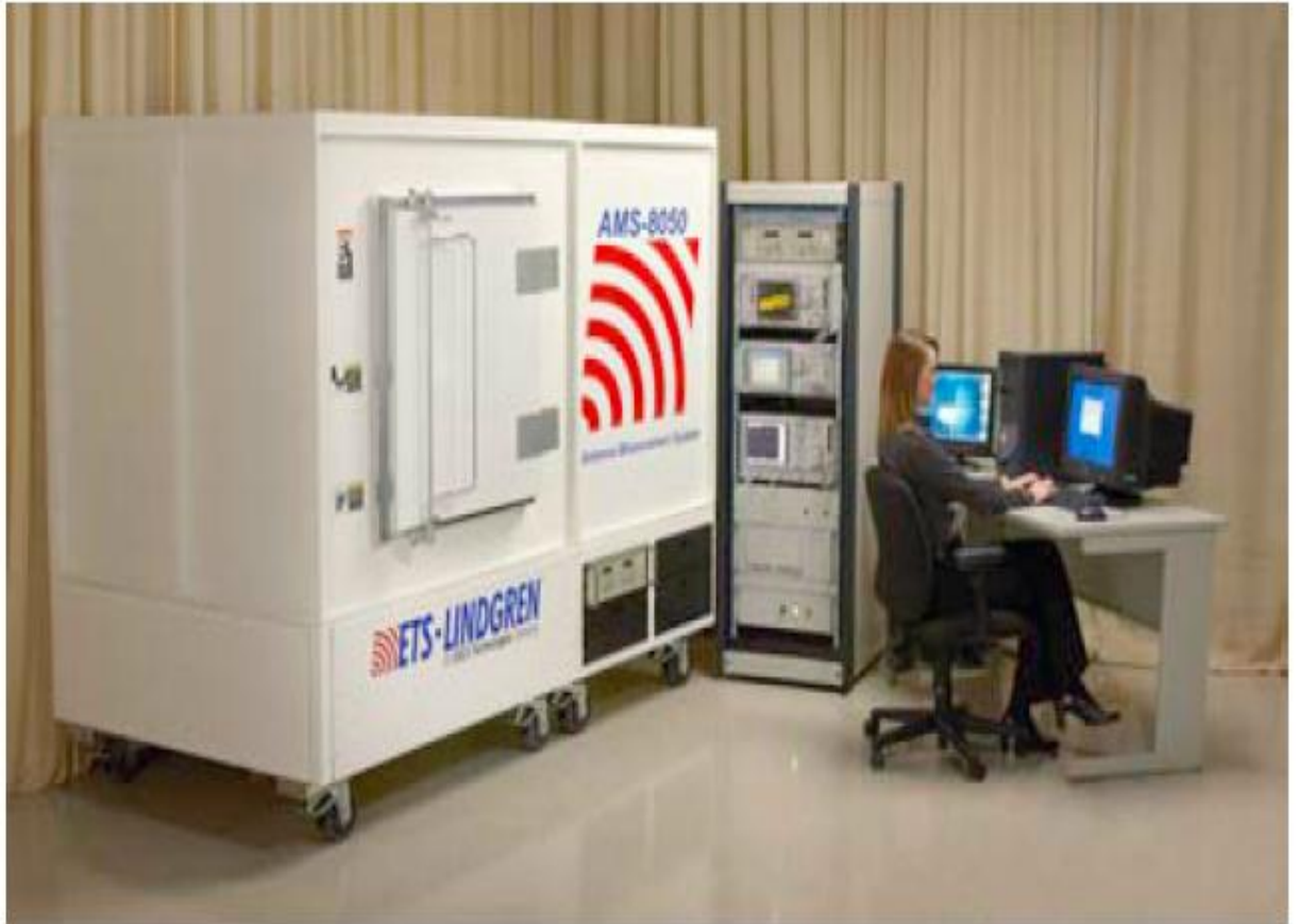
Kuva 6. Häiriösuojakammio ja mittalaitteet /3/
