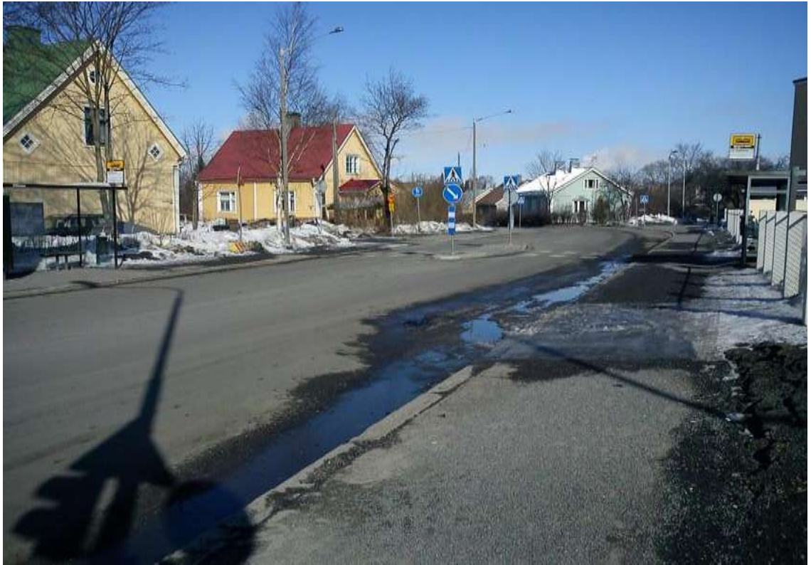
Kuva 27: Saarekkeet estävät pysähtyneen linja-auton ohitukset. (Kuva: Mikko Heikkilä).
