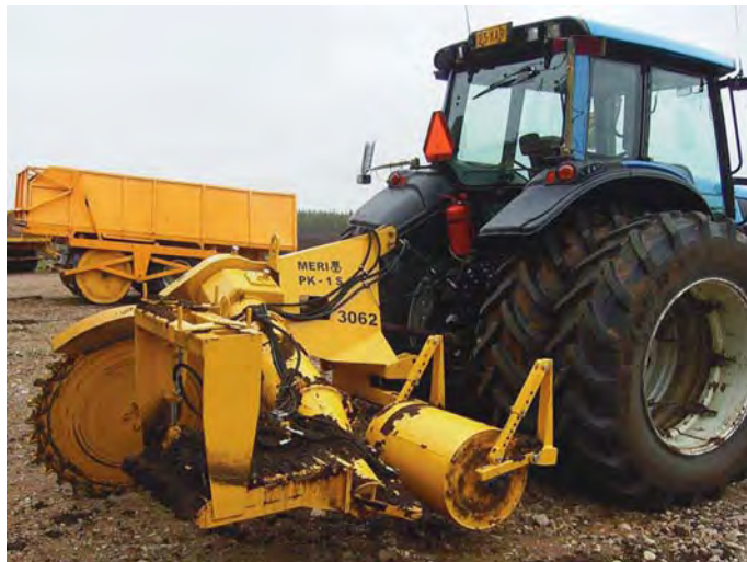
Kuva 26. Suokone Oy:n valmistama palaturpeen nostokone Meri PK-1S (Turveruukki Oy).
