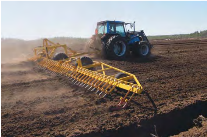
Kuva 19. Muovilusikoilla varustettu kääntäjä (Tero Vesisenaho).
