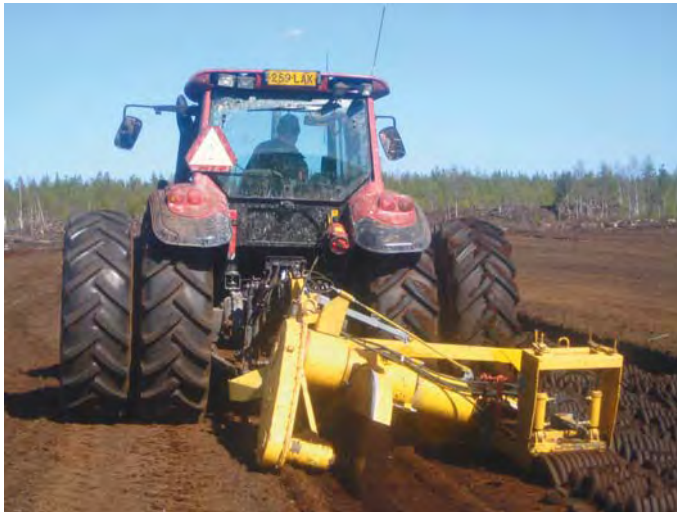
Kuva 28. Palaturpeen muotoilua lainepalasuuttimilla (Mari Juntunen).
