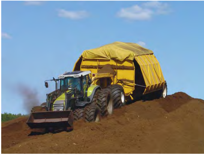
Kuva 35. Päälleajoauma tehdään ajamalla kuorman kanssa auman päälle ja purkamalla kuorma ajon aikana (Turveteollisuusliitto ry).
