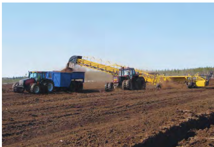
Kuva 21. Turpeen kuormaus Haku-menetelmässä (Tero Vesisenaho).
