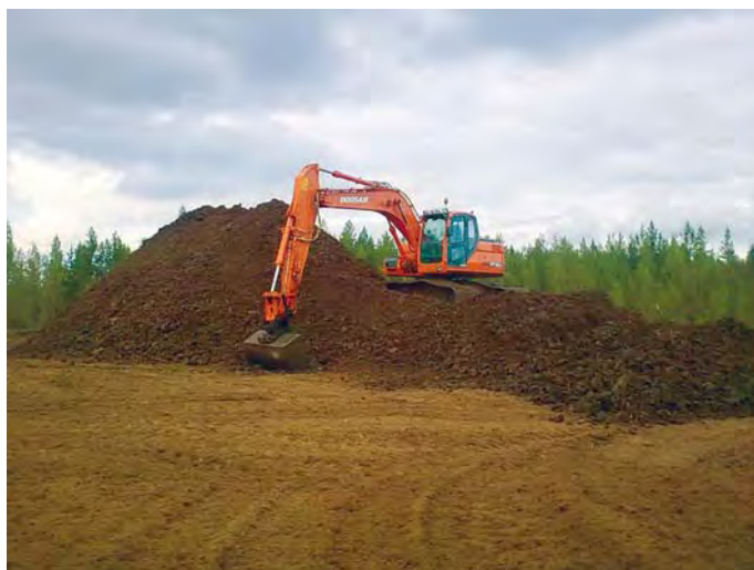
Kuva 36. Seulomattoman palaturpeen aumaus kaivinkoneella (Mari Juntunen).
