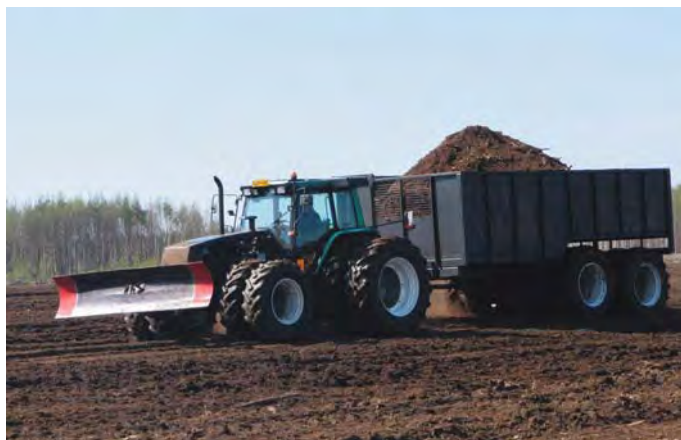
Kuva 22. Turpeen ajo aumaan Haku-menetelmässä (Tero Vesisenaho).
