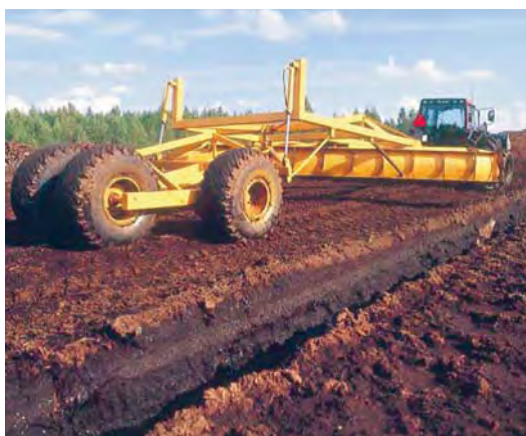
Kuva 10. Suolanalla tasoitetaan kentät suon valmisteluvaiheessa sekä tuotannon aikana (Vapo Oy).
