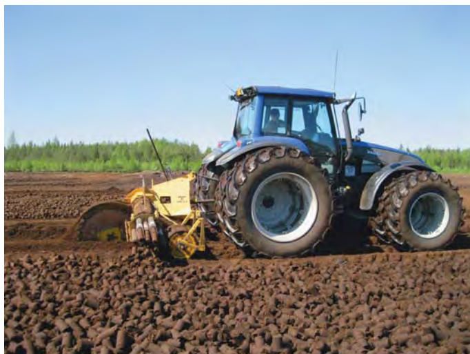
Kuva 27. Palaturpeen muotoilua sylinteripalasuuttimilla (Laura Vertainen).
