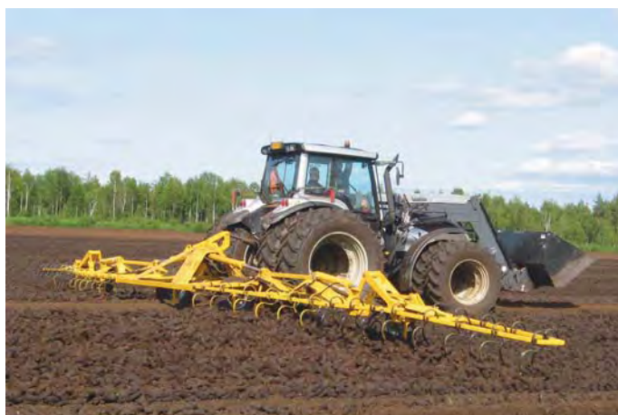
Kuva 32. Kääntö irrottaa alimmat palat kentästä ja nopeuttaa kuivumista (Suokone Oy).
