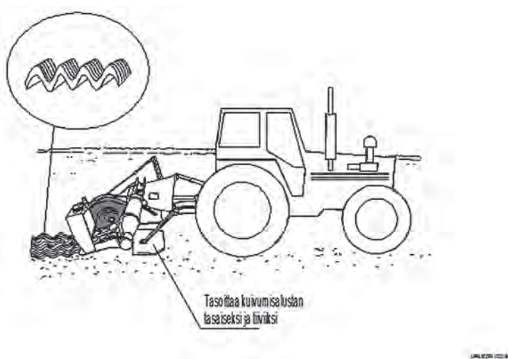
Kuva 30. Tasoituslevy tasoittaa kuivumisalustan (VTT).
