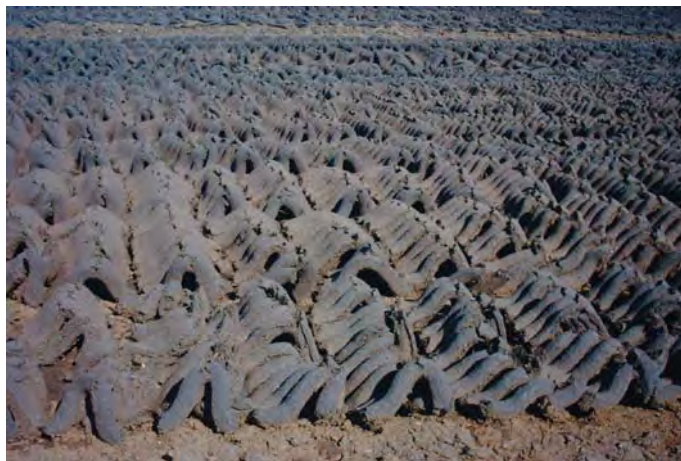
Kuva 31. Kuivumisen edetessä lainepalat kutistuvat ja irtoavat toisistaan (Pekka Hölttä).
