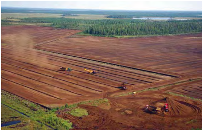
Kuva 14. Haku-menetelmän koneketju. Jyrsinturpeen kuormaus, ajo ja aumaus (Turveruukki Oy).
