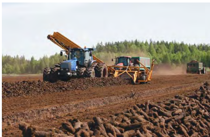
Kuva 33. Palaturpeen kuormaus hihnakuormaajalla (Turveteollisuusliitto ry).
