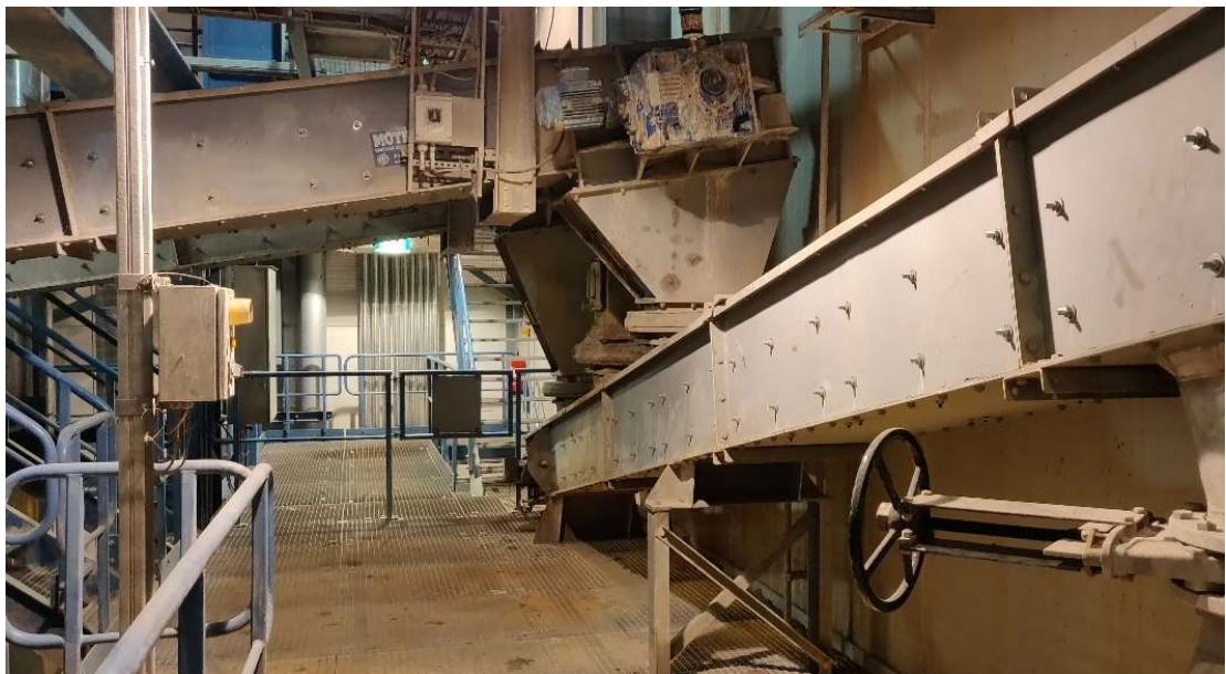
Kuva 7. Säteilevän osan oikea ja vasen ketjukuljetin sekä ensimmäinen yhteinen kuljetin
