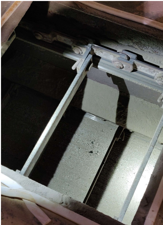
Kuva 5. Ketjukuljettimen sisällä kuljetettava lentotuhka
