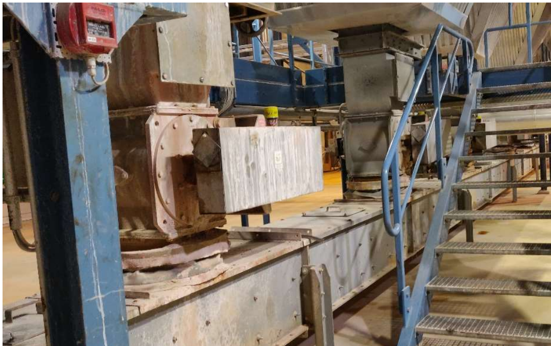
Kuva 6. Konvektiivisen osan sulkusyöttimet ja ketjukuljetin
