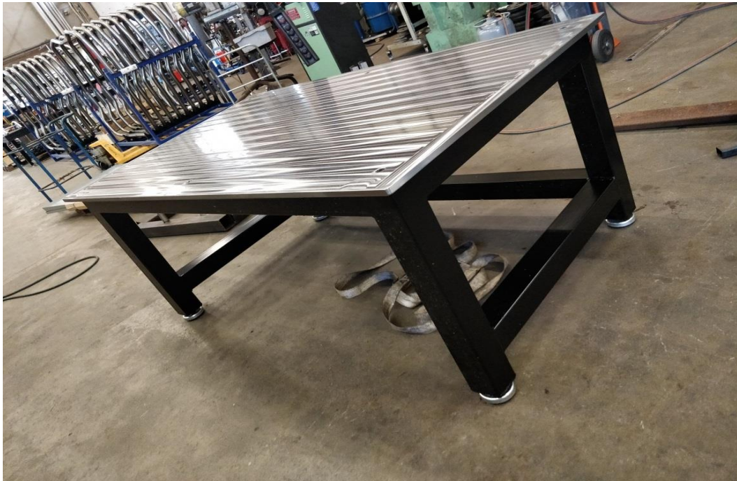
Kuva 13. Metallinen mittauspöytä, koneistetulla kannella.
