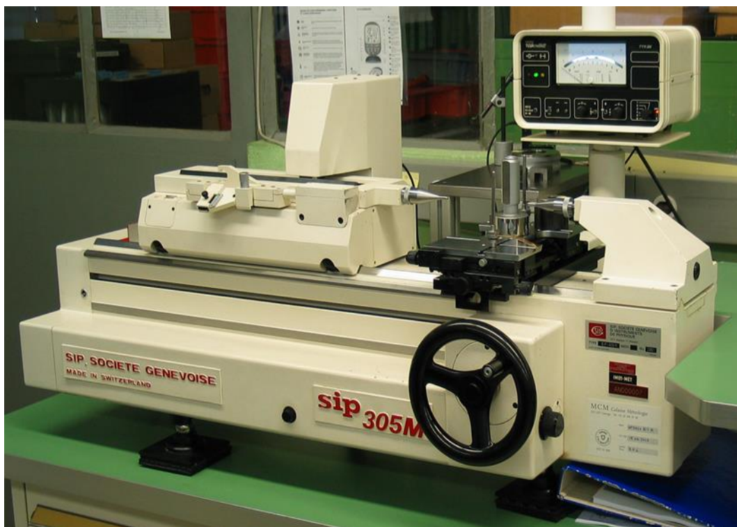
Kuva 3. Sip 305M -mittauspenkki. /6/
