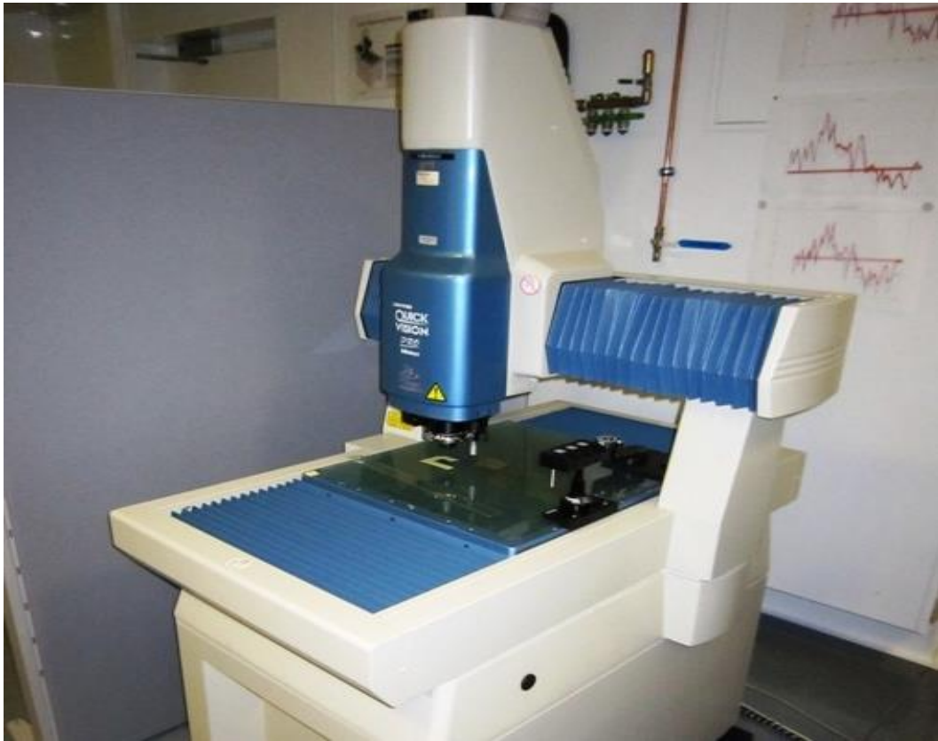
Kuva 8. Mitutoyo Quickvision Hyper QV-350 -videomittauskone. /9/
