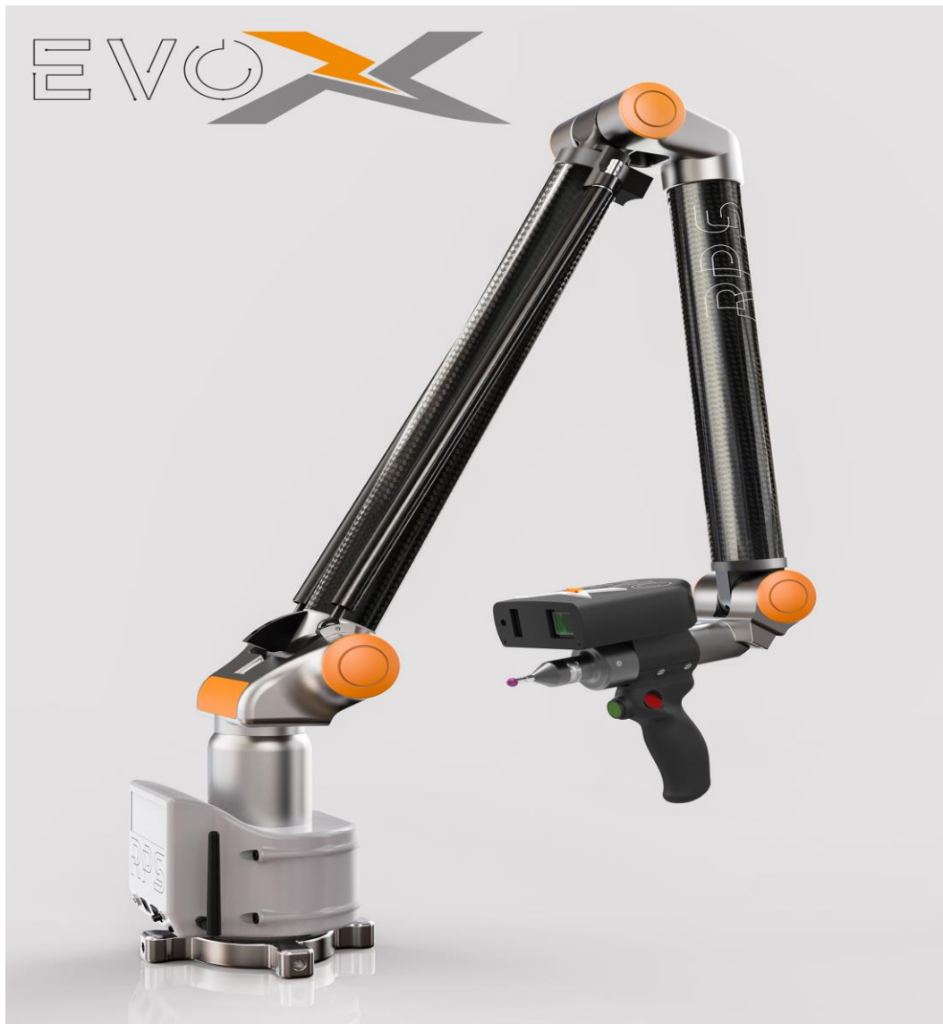
Kuva 12. RPS EVO-XR 7 -nivelsikoordinaattimittauskone. /12/
