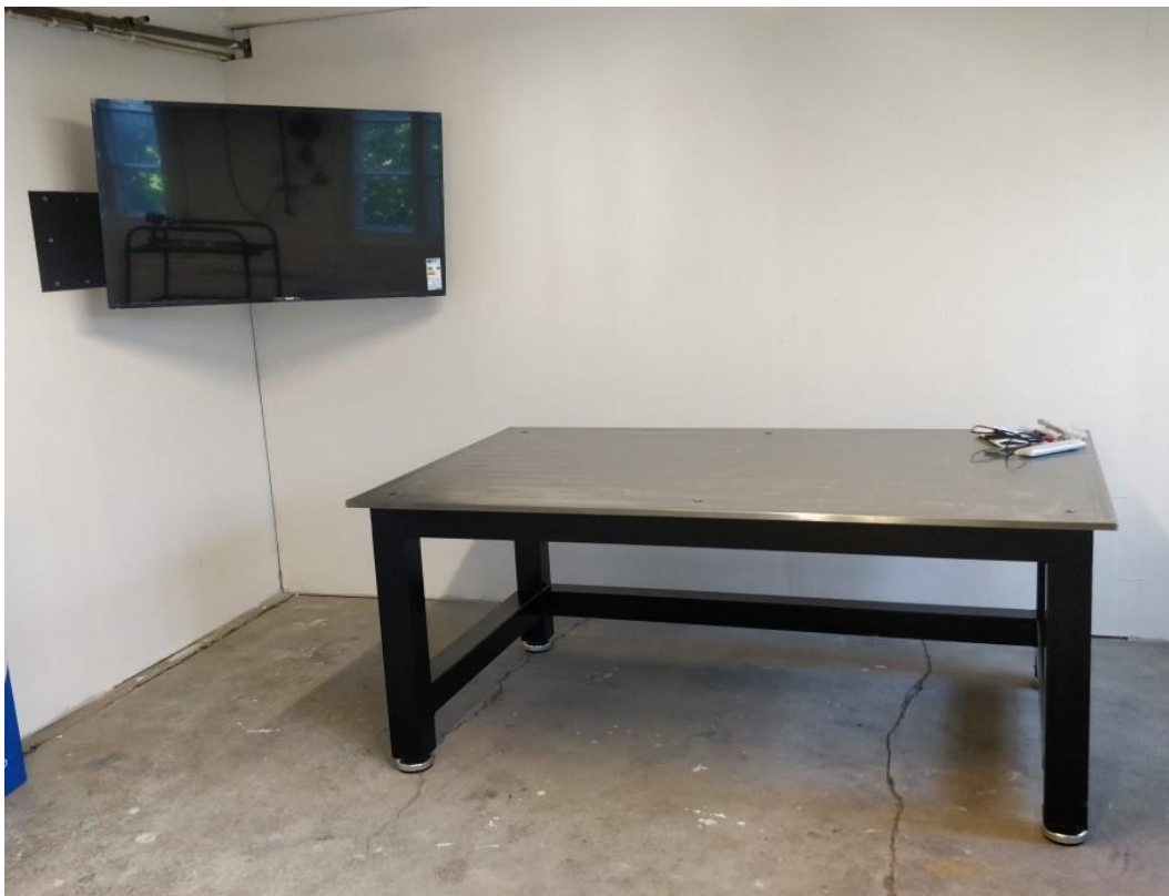
Kuva 13. Metallinen mittauspöytä, koneistetulla kannella.
