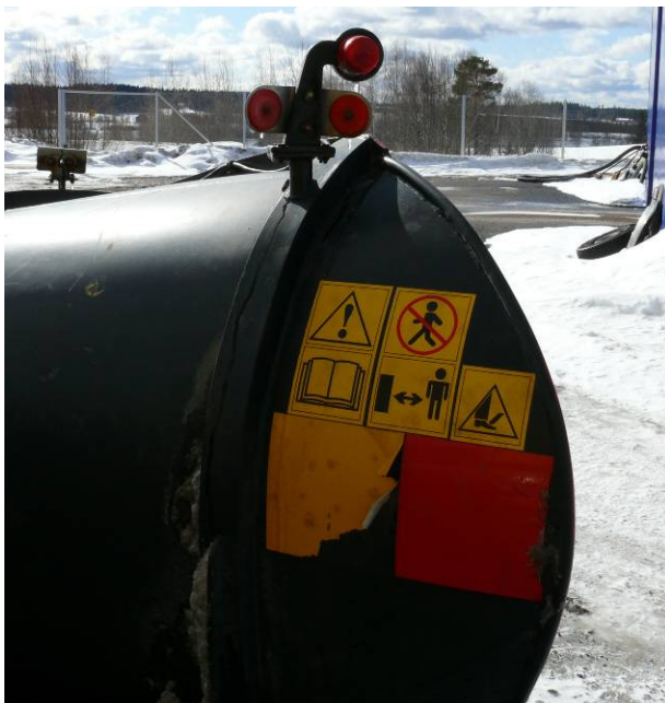
Kuva 22. Etuauran oikeaan kärkeen asennettu heijastinkalvo.
