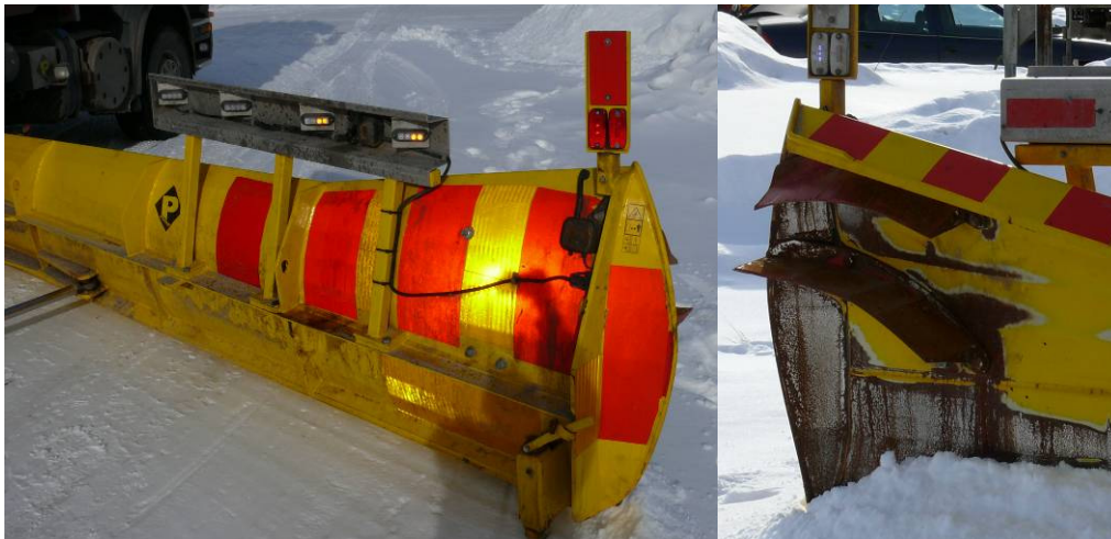
Kuvat 16 ja 17. Leveä sivuaura, jossa neljä LED-vilkkua ja heijastavaa kalvoa. Sivuauran lumenohjaimia.
