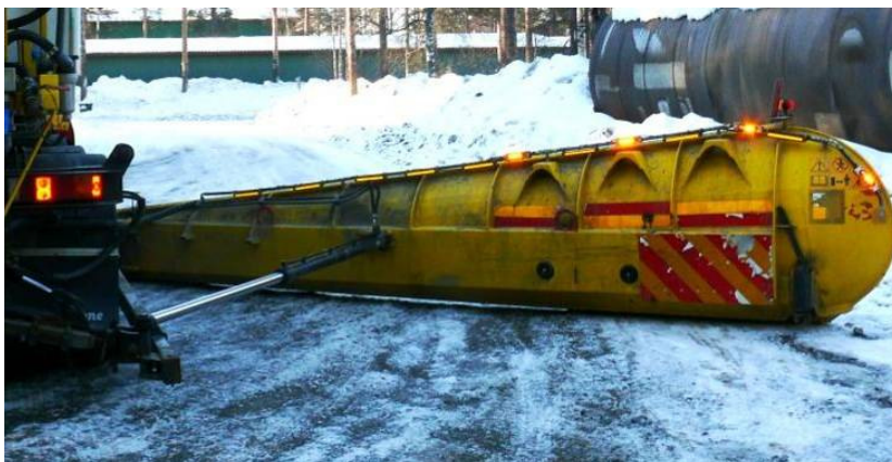
Kuva 29. Leveä sivuaura. Lisävarusteena keltaisia vilkkuvia valaisimia.
