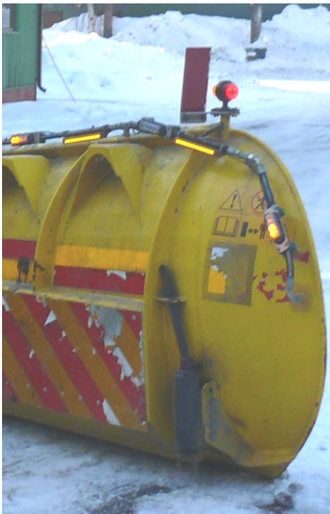
Kuvat 26 ja 27. Sivuauran kärjen varoituslaitteita.
