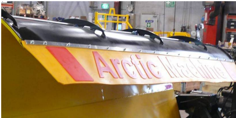
Kuvat 23 ja 24. Auran yläreunassa roikkuva kuminen lippa.
