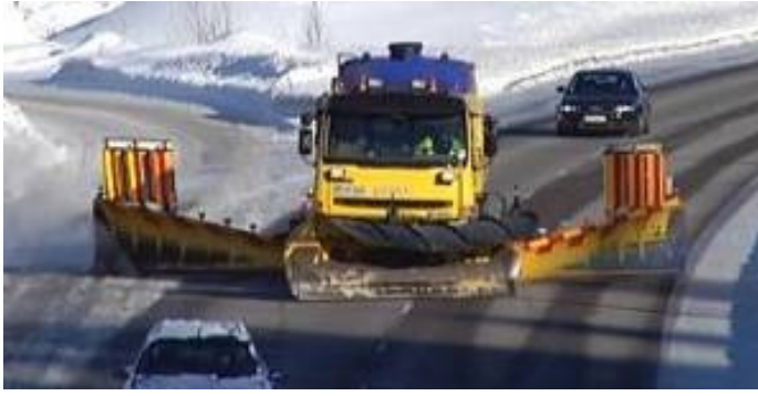
Kuva 31. "Tupla-aura", leveä sivuaura + kääntöaura + leveä sivuaura (YLE uutiset, 2011).
