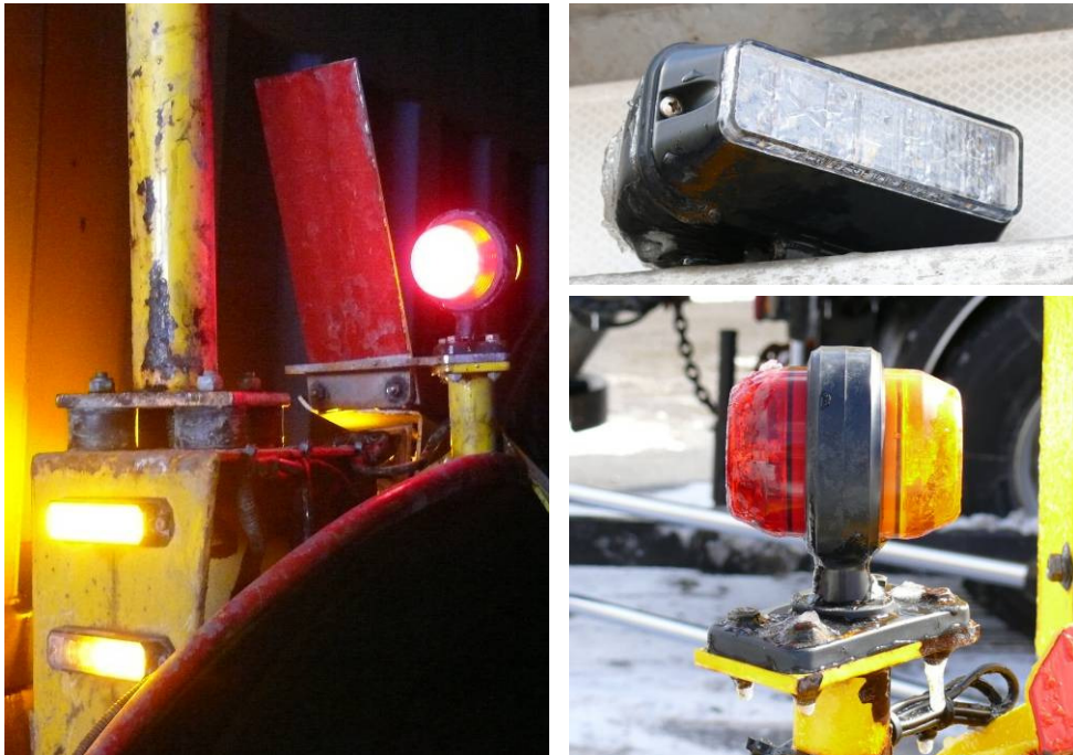
Kuvat 9, 10 ja 11. Auran LED-valaisimia. Ylhäällä oikealla keltainen, vilkkuva LED
