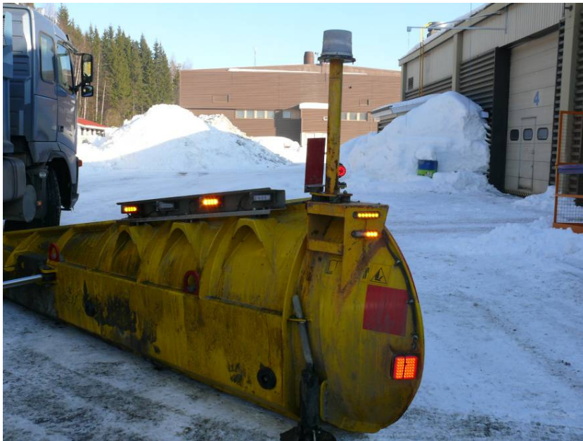
Kuva 28. Leveä sivuaura kokonaisuudessaan. Lisävarusteena korkealla varren päässä oleva LED-valaisinmajakka ja äärioikealla alareunassa oleva ylimääräinen punainen valaisin.
