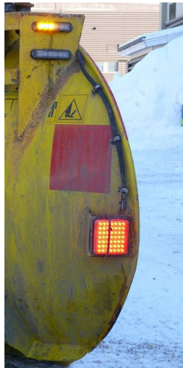
Kuvat 26 ja 27. Sivuauran kärjen varoituslaitteita.
