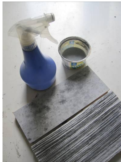
Kuva 20. Kalkkimaalipintojen sumutus kalkkivedellä.
