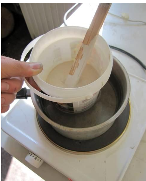
Kuva 15. Liimamaalin lämmitys vesihautteessa.
