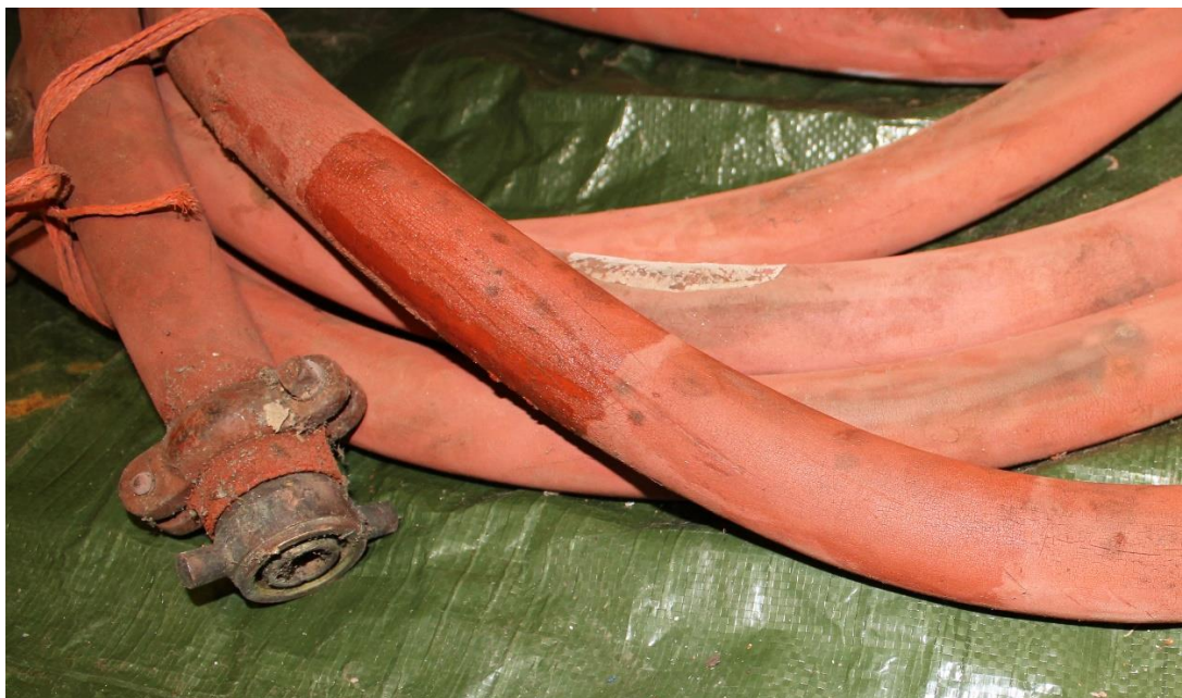
Kuva 28. Oranssin letkun konsolidointitestit. Primal tummempana, Lascaux haaleampana (Kiiski 2020)
