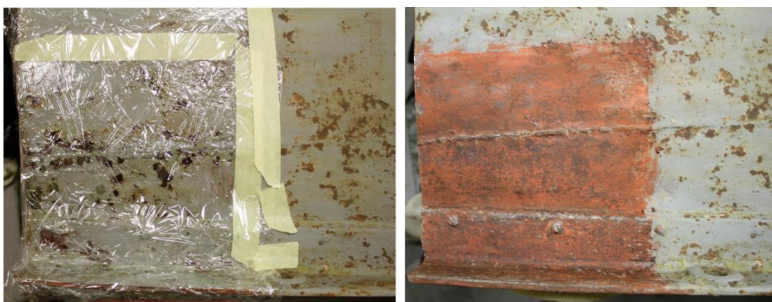
Kuva 21. Maalinpoisto ulkomuotin ovikappaleen ulkopinnasta (Kiiski & Mäkinen 2020)
