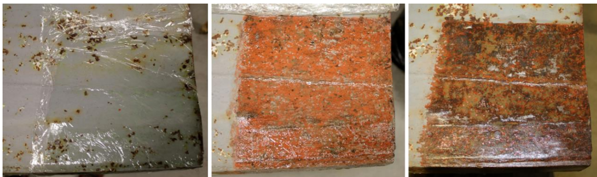
Kuva 20. Maalinpoisto ulkomuotin ovikappaleen sisäpinnasta maalikokeilua varten (Kiiski & Mäkinen 2020)
