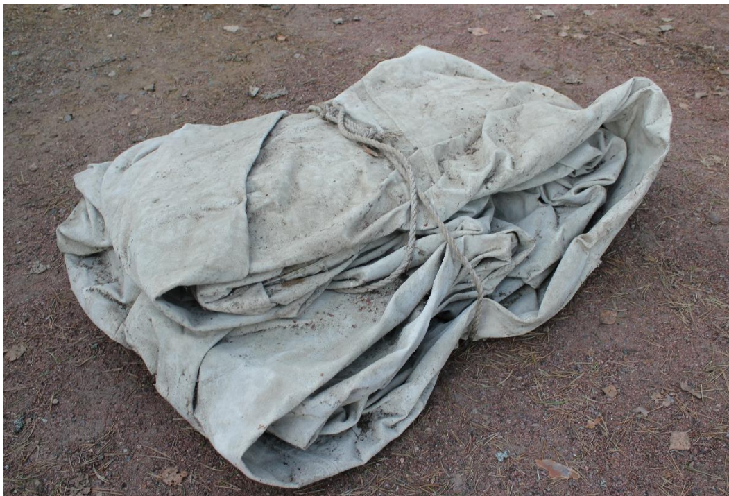
Kuva 16. Sisämuottipallon suojakangas (Mäkinen 2020)
