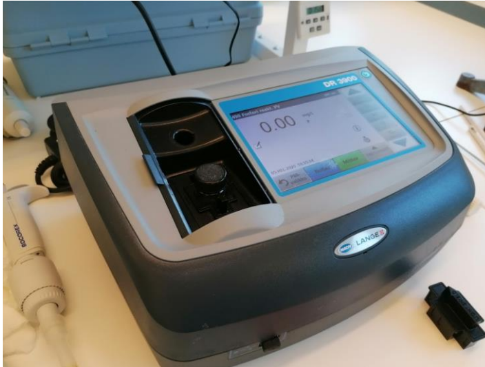
Kuva 19. Fosforin määrittäjä HACH DR 3900.
