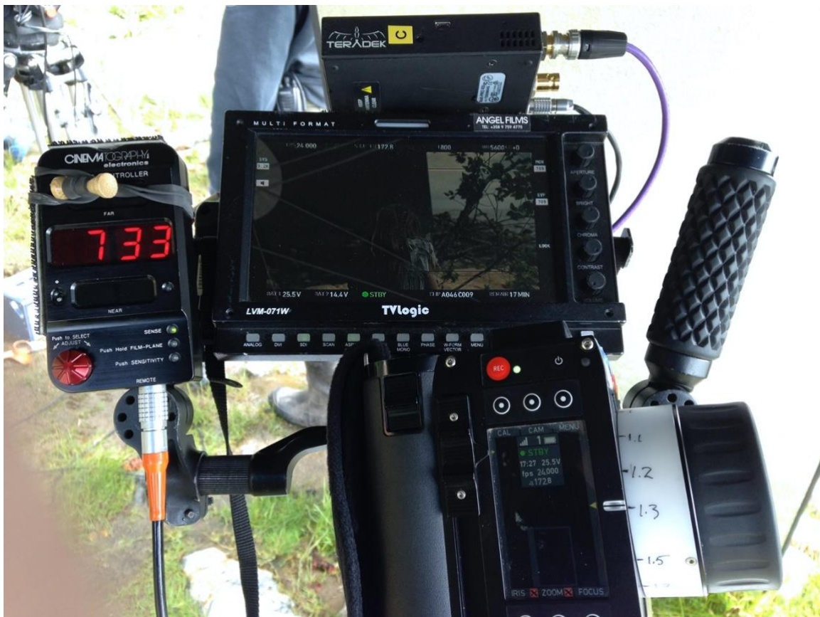
Figur 3. Kamera-assistentens främsta arbetsredskap WCU med Cinetape avståndsmätare, monitor, Teradek Bolt och avståndsskala. Fotograf Raimo Paananen 2015.
