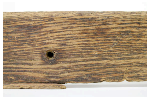
Kuva 6. Kannen etusarjan alle sijoitettu profiililista. Profiililista katkennut puoliksi etureunan osalta. Katkeamiskohta lähikuvassa. Valokuvaaja Mikko Iivonen
