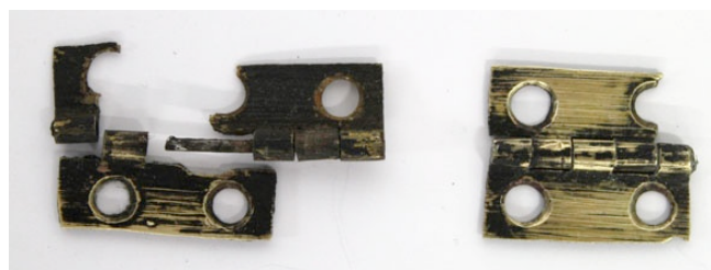
Kuva 3. Messinkisaranat ovat haljenneet esineen huonon säilytyksen vuoksi. Valokuvaaja Mikko Iivonen
