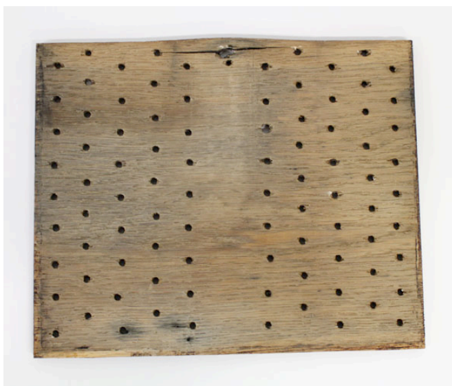
Kuva 7. Puhdistustesteissä käytetty välipohjan osa. Kuva on otettu kaikkien testien jälkeen. (Iivonen 2011)
