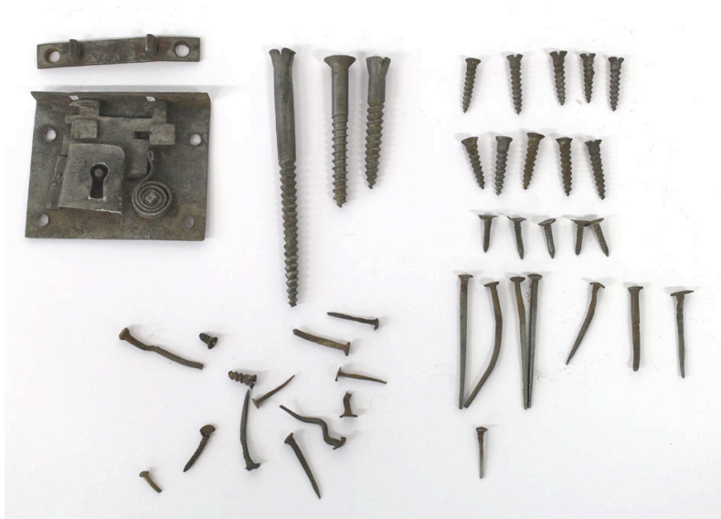
Kuva 10. Rautalukko, ruuvit ja naulat on puhdistettu 10-prosenttisellä sitruunahappoliuoksella. (Iivonen 2011)
