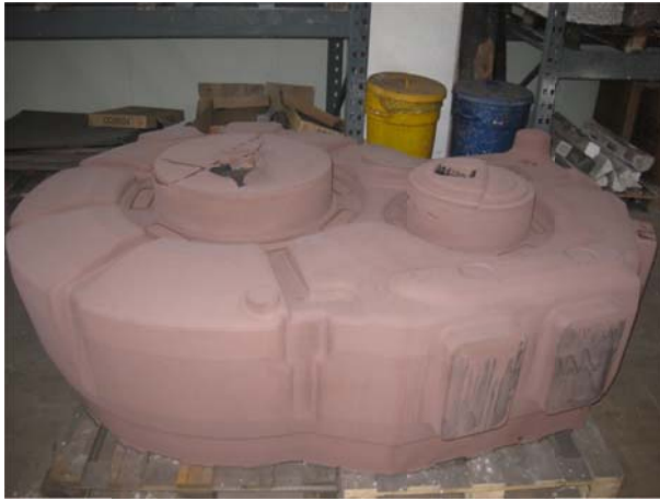
KUVIO 6. Vaihdelaatikon kotelon keerna.
