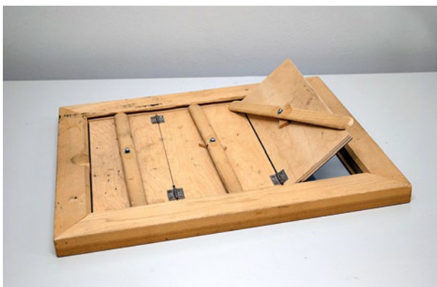
Kotitekoinen vedostuskehys, jonka takaosa on jaettu kolmeen erikseen aukeavaan ja saranoituun osastoon.
