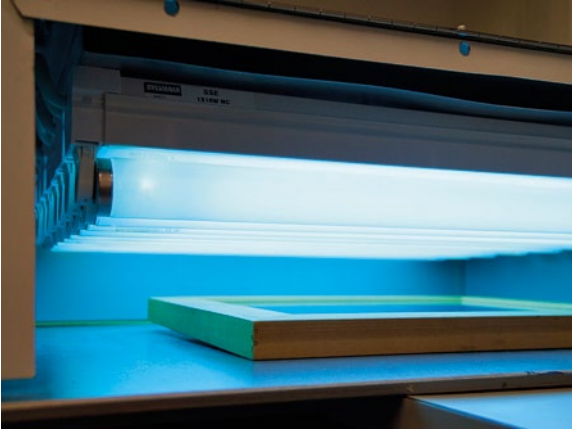
UV-valotuslaite, mallia ”pizzauuni”, on yksinkertainen laatikko, jonka katossa on sarja UV-loisteputkia, ja vedostuskehys voidaan työntää laatikkoon valottumaan.
