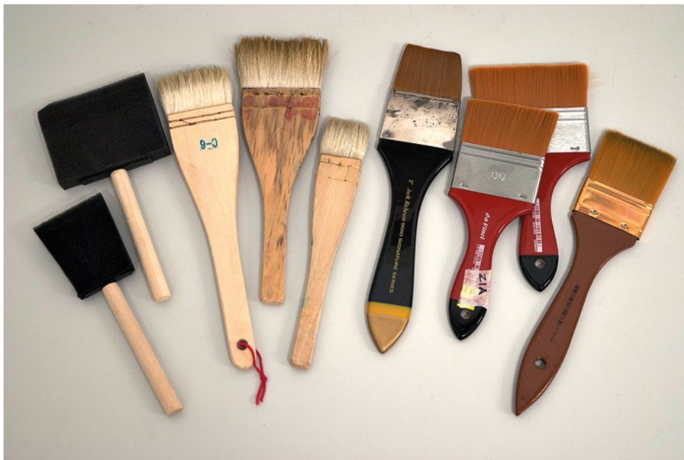
Erilaisia herkistysliuosten levittämiseen käytettäviä siveltimiä. Vasemmalla kaksi huokeaa vaahtomuovisivellintä, seuraavana kolme erikokoista puuvartistista hake-sivellintä ja oikealla ryhmä siveltimiä synteettisillä harjaksilla.
