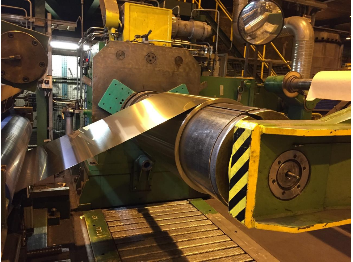
Kuva 2. Halkaisulinja 2:n päällekelain
