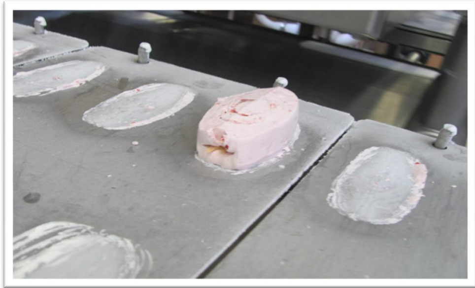
Kuva 2 Esimerkki Classic metsämansikkan hävikistä 1-rivin lämpökuormalla
