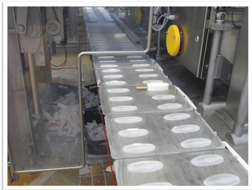
Kuva 1 Classic maitosuklaa hävikkiä 2-rivisessä ajossa, -32\text{ }^{\circ}\text{C} .
